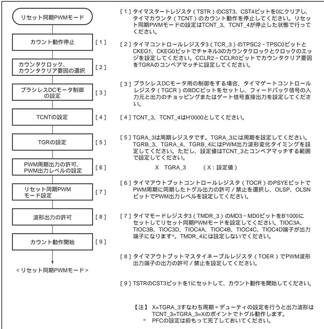
図 10.30 リセット同期 PWM モードの設定手順例
