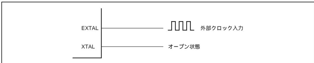
図 4.4 外部クロックの接続例
