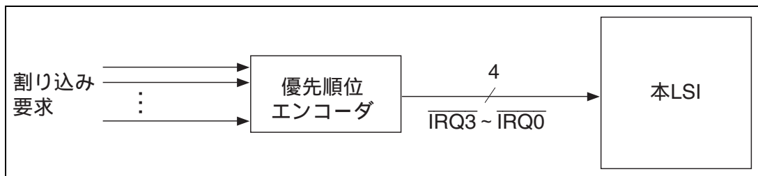
図 6.2 IRL モード割り込みの接続例
