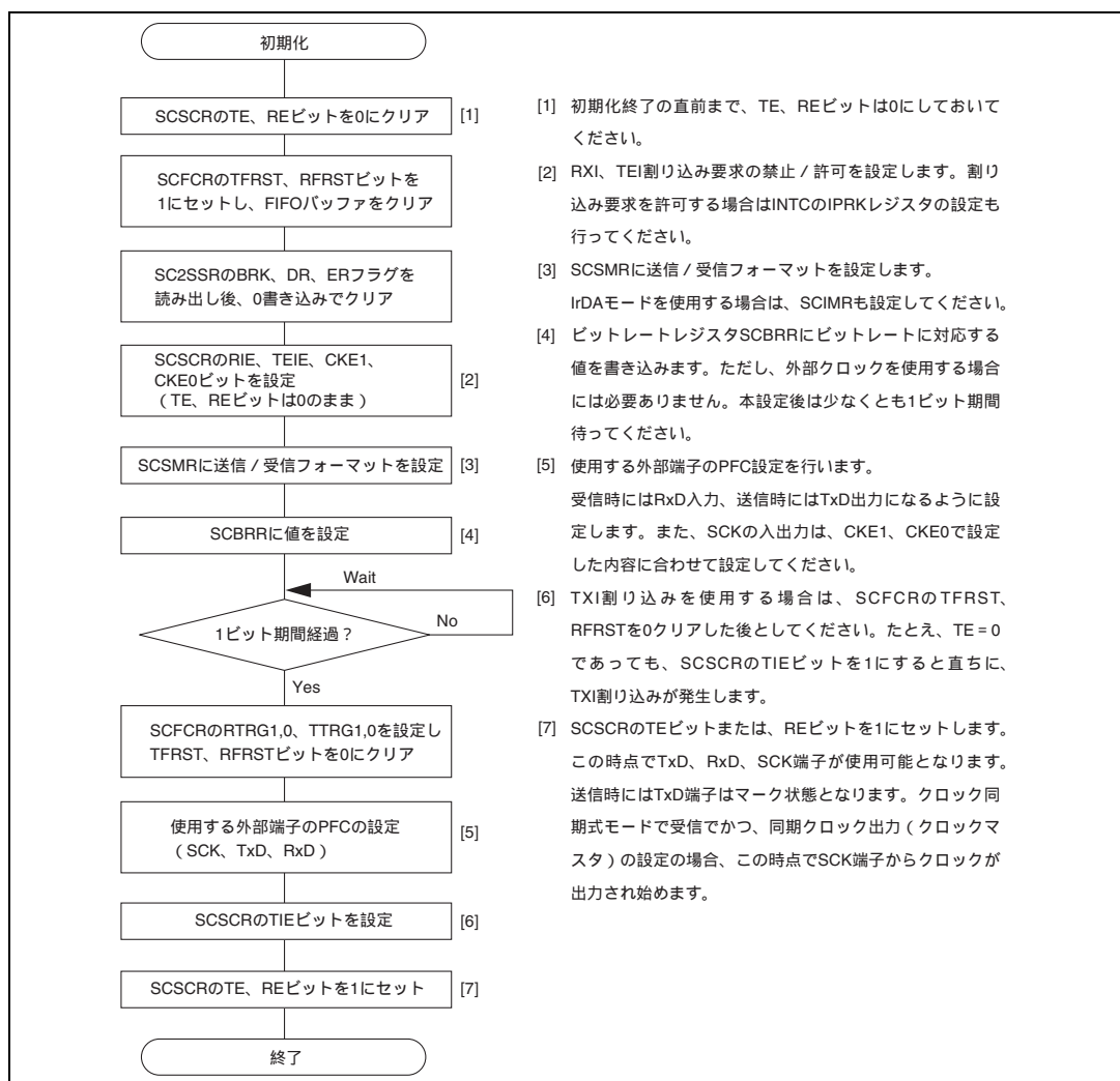
図 14.17 SCI の初期化フローチャートの例
