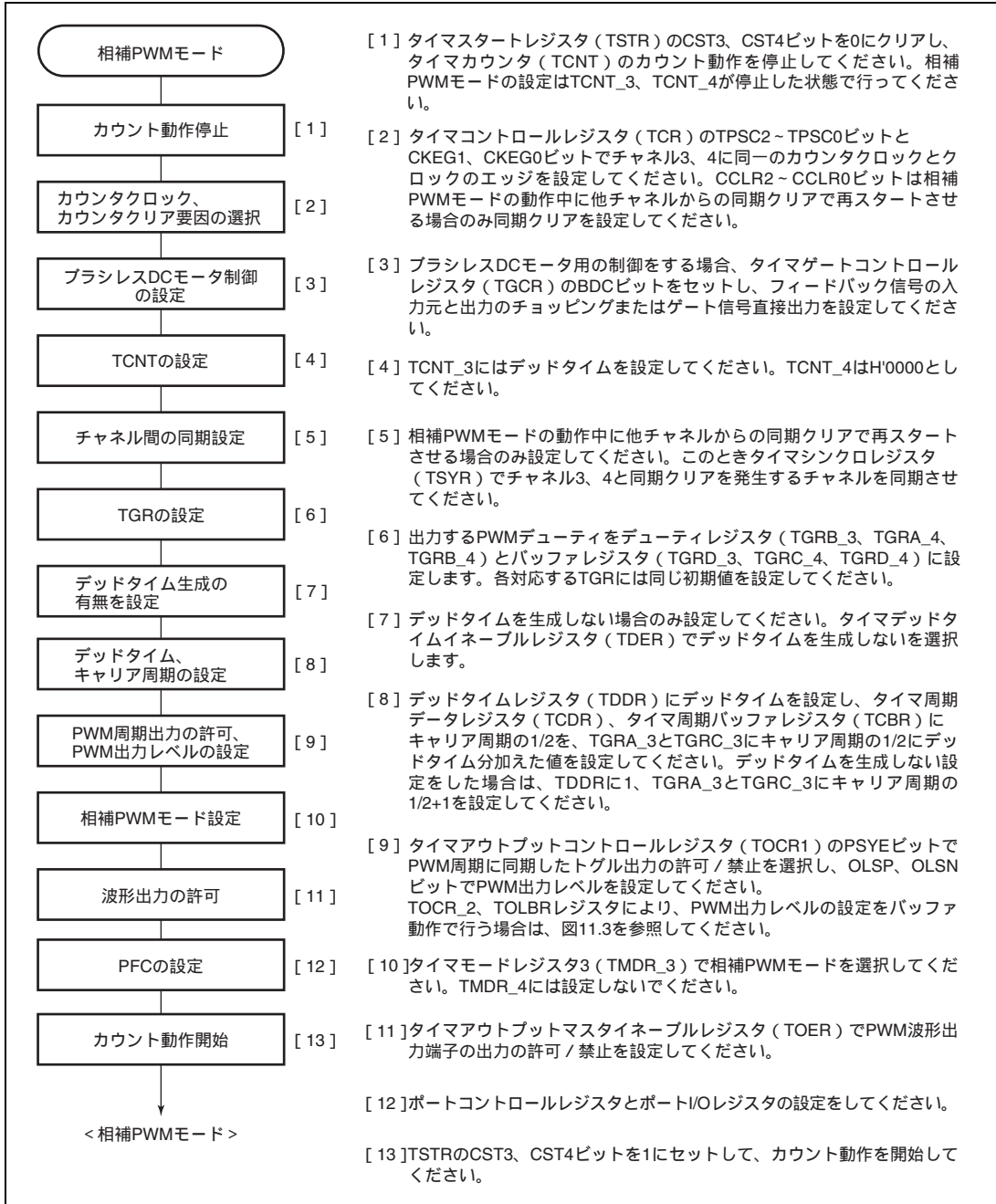
図 11.38 相補 PWM モードの設定手順例
