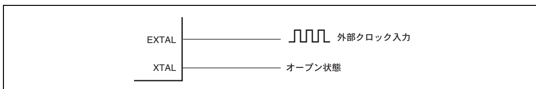
図 4.4 外部クロックの接続例
