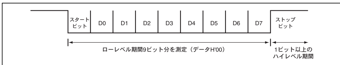
図 27.7 ビットレート自動調整時の SCI 送受信フォーマット
