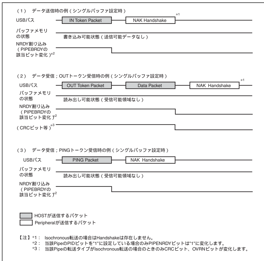
図 27.4 ファンクションコントローラ機能選択時の NRDY 割り込み発生タイミング図
