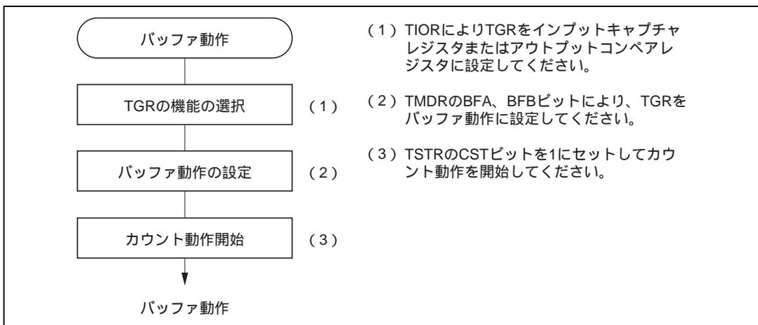
図 17.18 バッファ動作の設定手順例
