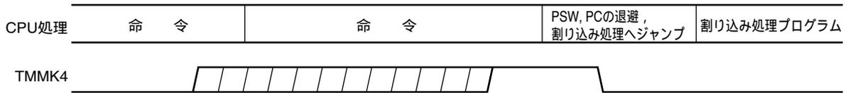
図13 - 10 ノンマスクابل割り込み要求の受け付け動作
