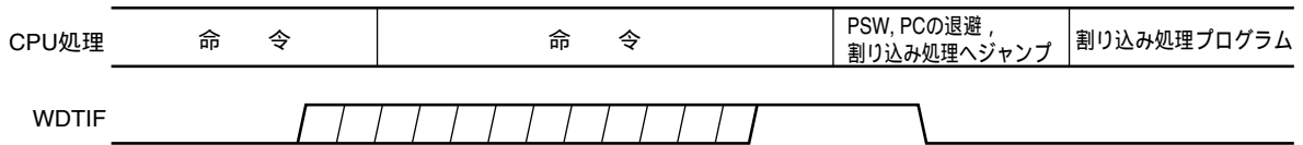
図16 - 11 ノンマスクブル割り込み要求の受け付け動作
