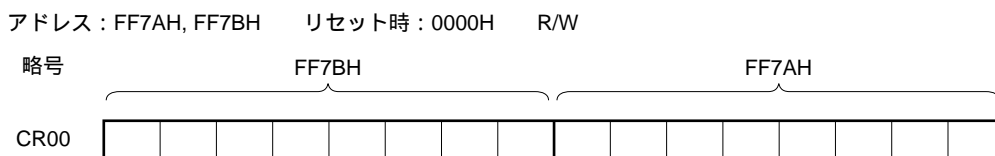
図8 - 3 16ビット・タイマ・キャプチャ/コンペア・レジスタ00(CR00)のフォーマット
