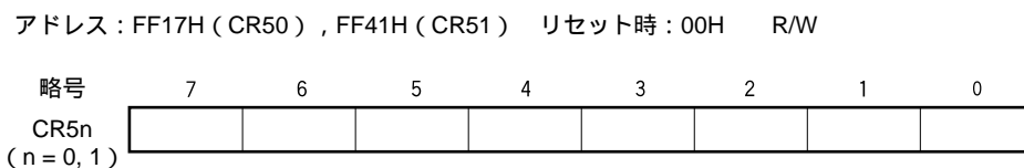
図7-4 8ビット・タイマ・コンペア・レジスタ5n (CR5n) のフォーマット
