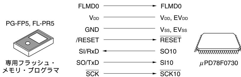
図19 - 6 専用フラッシュ・メモリ・プログラマとの通信 (CSI10)
