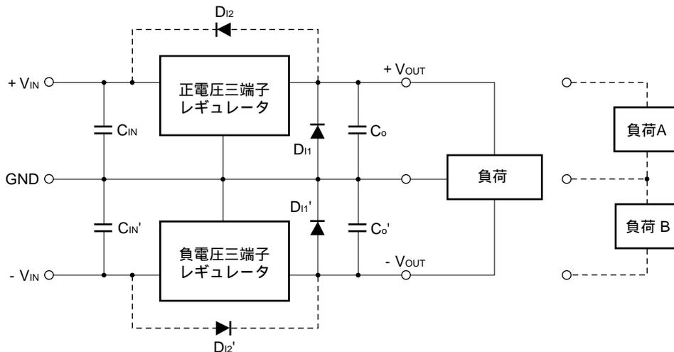
$C_{IN}, C_{O}$  : 単電源負荷の回路例と同様、必要です。
