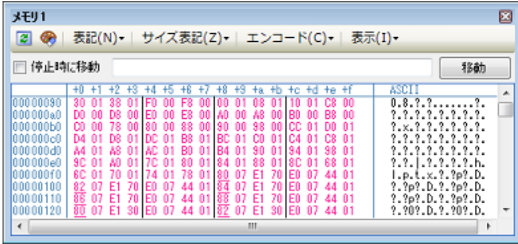
図 2.42 リアルタイム表示更新を行っているメモリ表示の例（メモリパネル）
