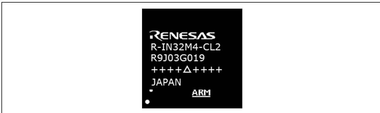
図23.1 R-IN32M4-CL2 捺印情報
