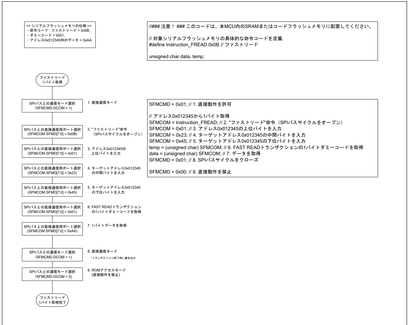
図 31.39 ファストリード命令による1バイト取得のフローチャート
