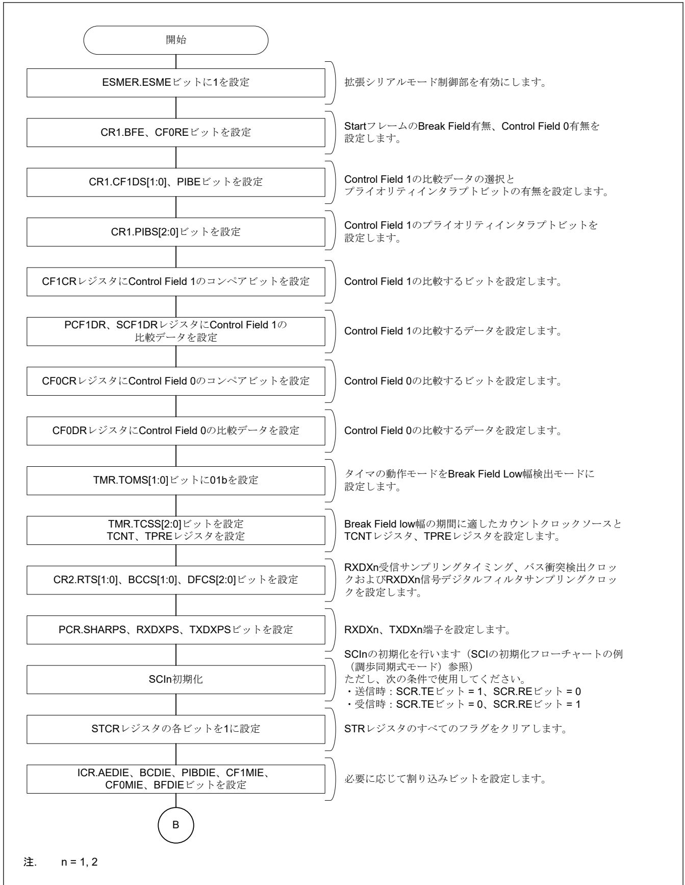
図 27.107 Start Frame 受信フローチャート例 (1)
