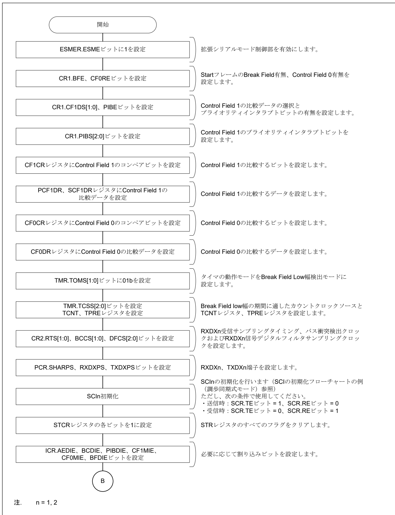
図 27.107 Start Frame 受信フローチャート例 (1)
