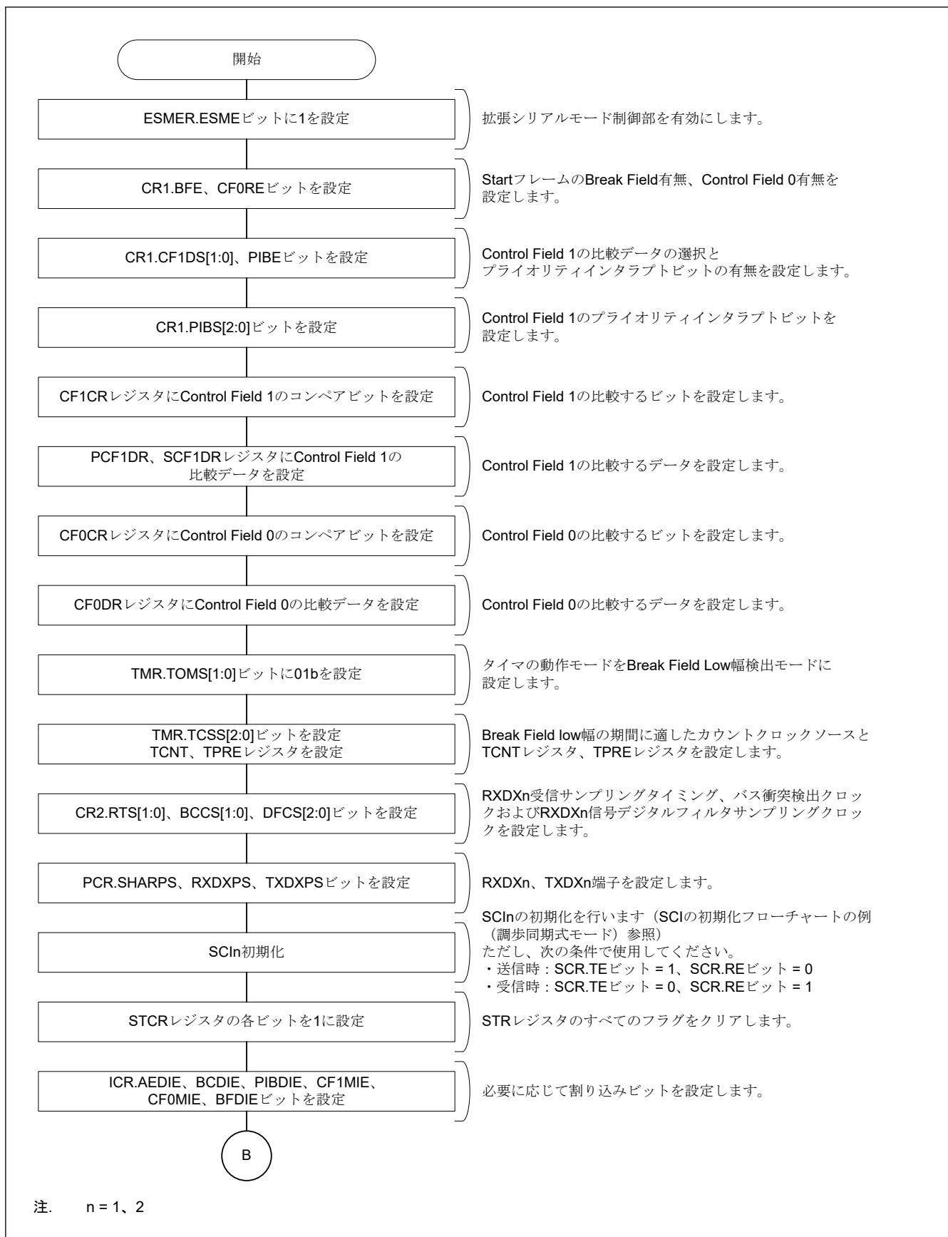
図 29.107 Start Frame 受信フローチャート例 (1)
