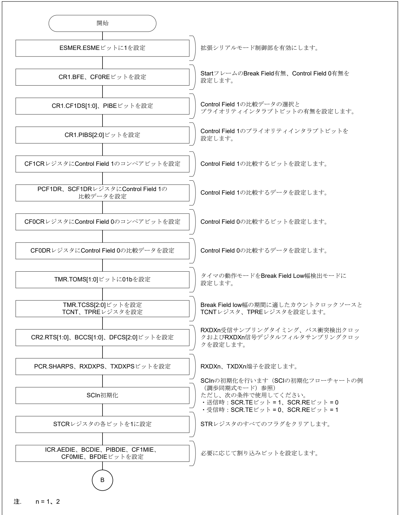
図 30.107 Start Frame 受信フローチャート例 (1)
