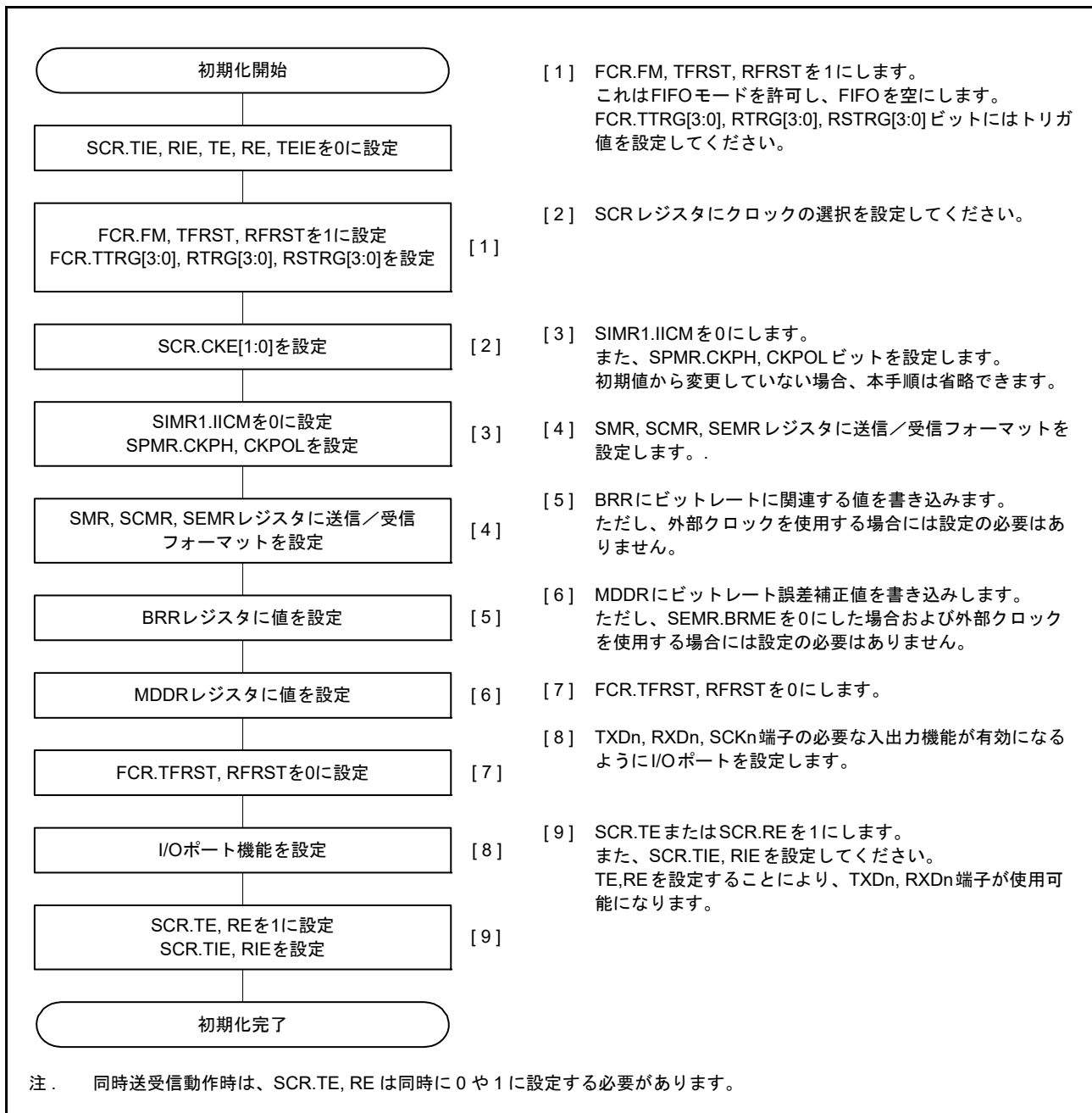
図 29.33 クロック同期式モードにおけるSCIの初期化フローチャート例 (FIFO選択時)
