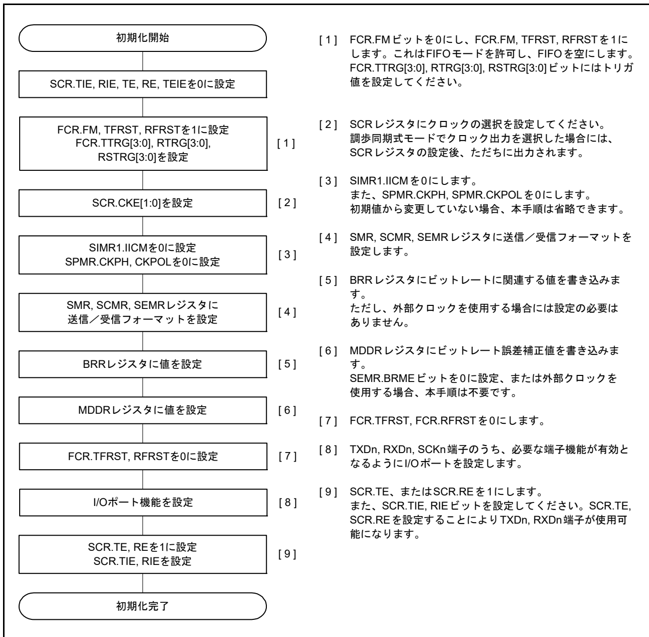
図 29.8 調歩同期式モードにおけるSCIの初期化フローチャート例 (FIFO 選択時)
