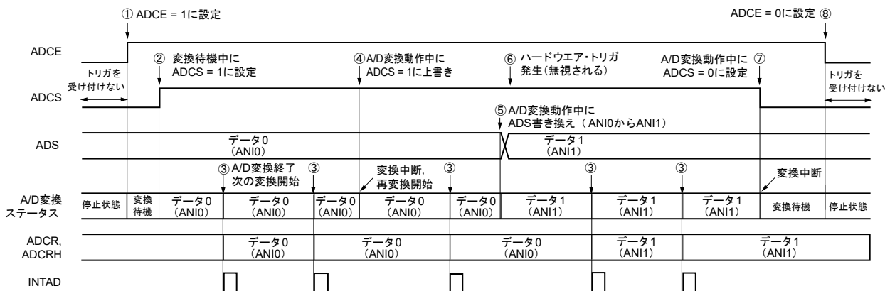
図10-17 ソフトウェア・トリガ・モード（セレクト・モード，連続変換モード）動作タイミング例
