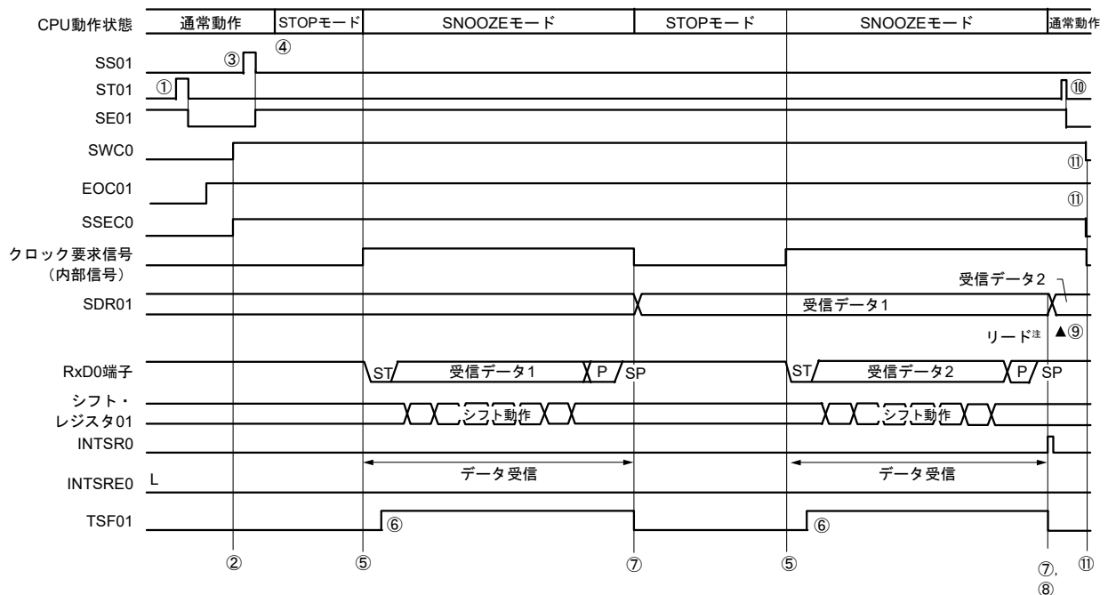
図12-93 SNOOZEモード動作 (EOCm1 = 1, SSECm = 1) 時のタイミング・チャート
