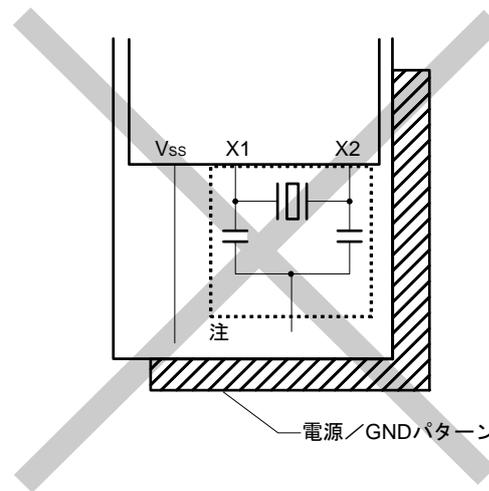
**注** 多層基板や両面基板において、X1端子、X2端子と発振子の配線部（図中の点線部分）の下には、電源/GNDパターンを配置しないでください。
