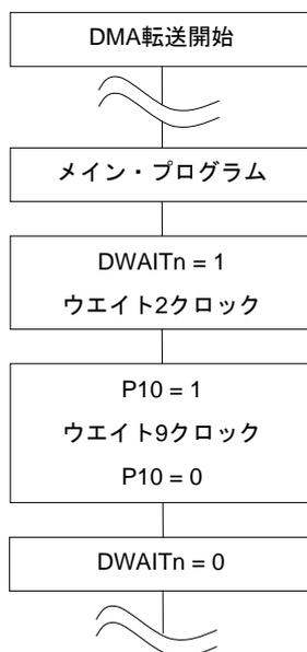
**注意** DMAを2チャンネル以上使用中でDMA転送を保留したい場合は、必ずすべてのチャンネルのDMAを保留にしてください (DWAIT0 = DWAIT1 = DWAIT2 = DWAIT3 = 1)。他チャンネルのDMAが保留中に一つのチャンネルのDMA転送が実行されると、その他のチャンネルも保留されない場合があります。
