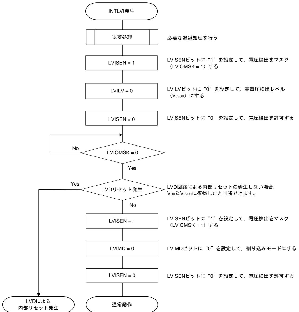
割り込み&リセット・モード (LVIMDS1, LVIMDS0 = 1, 0) を設定した場合、LVDリセット解除後 (LVIRF = 1) から400 μsか $f_{IL}$ の5クロック分の電圧検出安定待ち時間が必要です。電圧検出安定待ち後、LVIMDビットをクリア (0) して初期化してください。電圧検出安定待ち時間のカウント中およびLVIMDビットの書き換え時は、LVISEN = 1に設定してLVDによるリセットまたは割り込み発生をマスクしてください。
