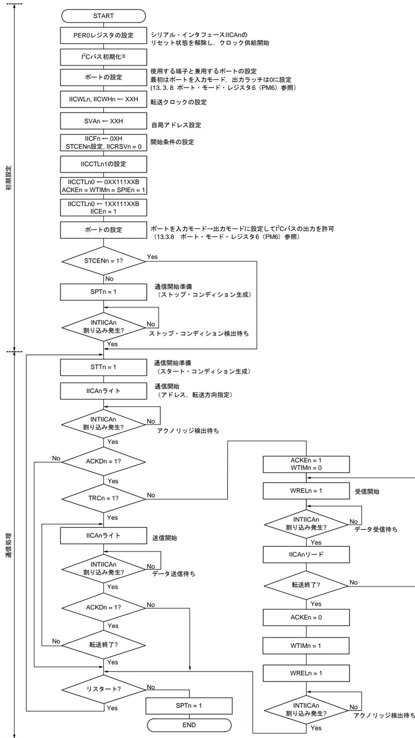
**注** 通信している製品の仕様に準拠し、I<sup>2</sup>Cバスを解放 (SCLAn, SDAAn端子 = ハイ・レベル) してください。たとえば、EEPROMがSDAAn端子にロウ・レベルを出力した状態であれば、SCLAn端子を出力ポートに設定し、SDAAn端子が定常的にハイ・レベルになるまで、出力ポートからクロック・パルスを出力してください。
