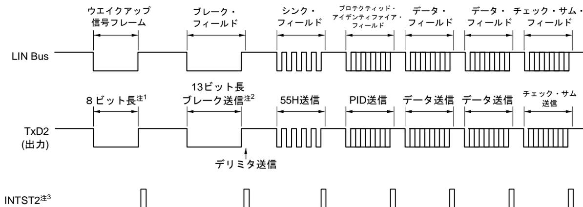
注1. ウエイクアップ信号の規定を満たせるようにボー・レートを設定し、80Hのデータ送信をすることで対応します。
