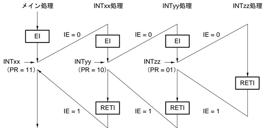
割り込みINTxx処理中に、2つの割り込み要求INTyy, INTzzが受け付けられ、多重割り込みが発生する。各割り込み要求受け付けの前には、必ずEI命令を発行し、割り込み要求受け付け許可状態になっている。
