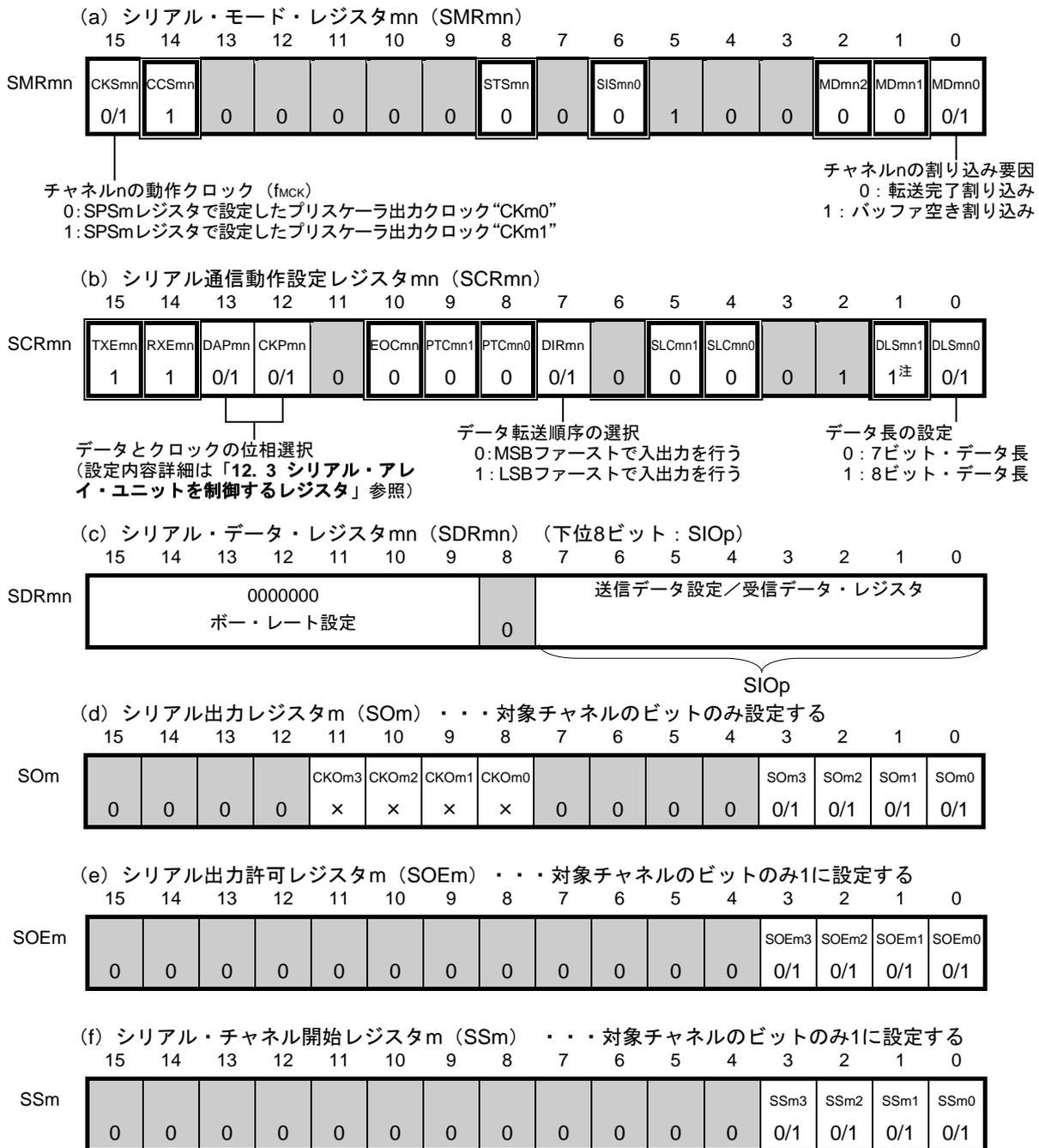
注 SCR00, SCR01レジスタと、100ピン製品のSCR10, SCR11レジスタのみ。その他は1固定になります。
