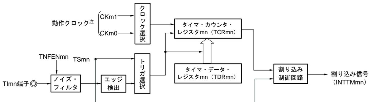
注 チャンネル1, 3の場合は、CK<sub>m0</sub>, CK<sub>m1</sub>, CK<sub>m2</sub>, CK<sub>m3</sub>からクロックを選択できます。
