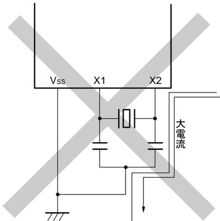
(f) 発振回路部のグラウンド・ライン上に電流が流れる
