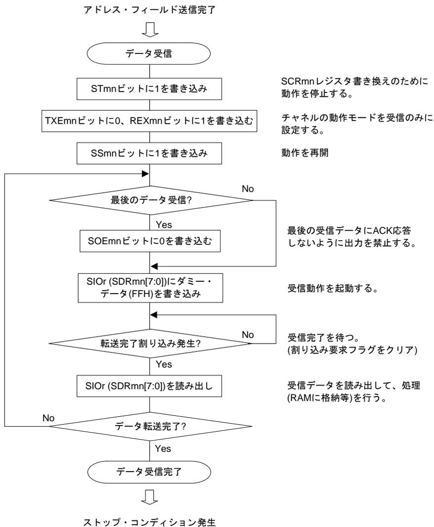
**注意** 最終データの受信時はACKを出力しません(NACK)。その後、シリアル・チャンネル停止レジスタm (STm)のSTmnビットに“1”を設定して動作停止としてから、ストップ・コンディションを発生することにより通信完了します。
