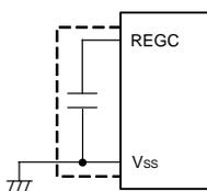
**注意** 上図の破線部分の配線を極力短くしてください。
