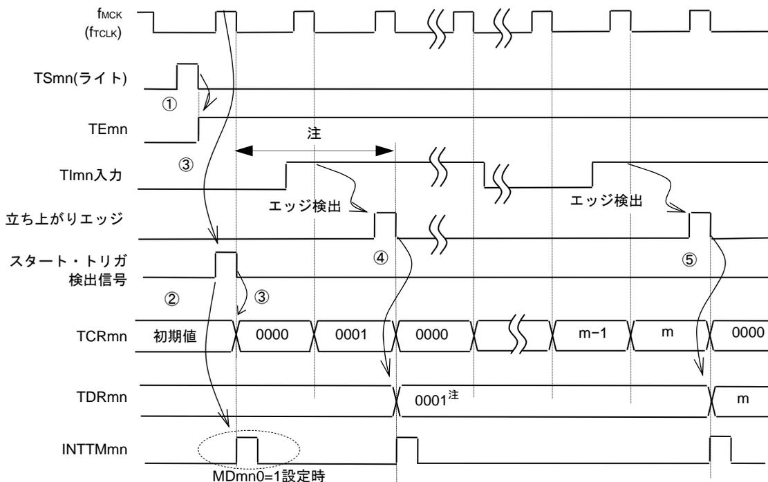
**注** スタート前からTImnにクロックが入力されている（トリガがある）場合、エッジ検出をしなくても、トリガ検出でカウントを開始するため、最初のキャプチャ（④）でのキャプチャ値はパルス間隔とならない（この例では0001：2クロック分の間隔）ので、無視してください。
