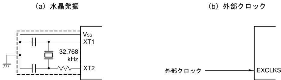
**注意** X1発振回路およびXT1発振回路を使用する場合は、配線容量などの影響を避けるために、図5-11、図5-12の破線の部分を次のように配線してください。
