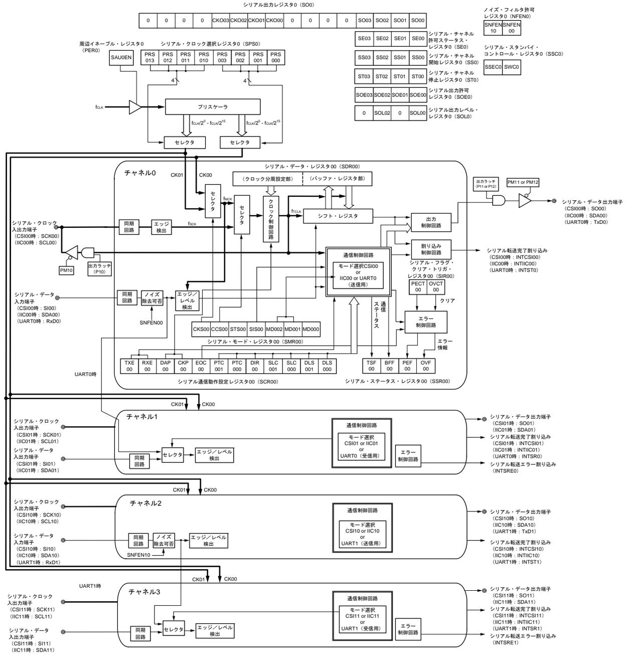
図12-2にシリアル・アレイ・ユニット1のブロック図を示します。
