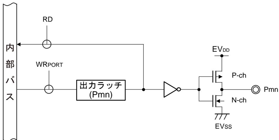
図2-2 端子タイプ 2-1-1 の端子ブロック図
