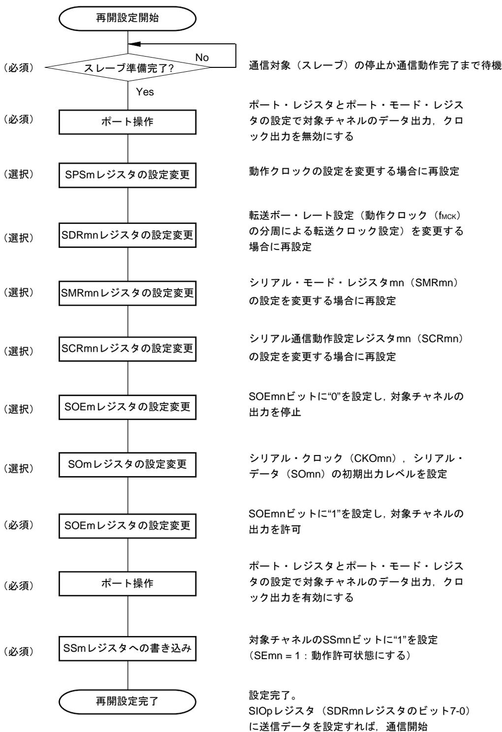
**備考** 中断設定でPER0を書き換えてクロック供給を停止した場合は、通信対象（スレーブ）の停止か通信動作完了を待って、再開設定ではなく初期設定をしてください。
