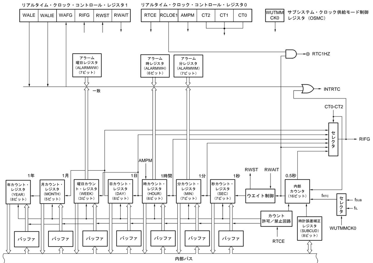
**注意** リアルタイム・クロックの動作クロックにサブシステム・クロック ( $f_{SUB} = 32.768 \text{ kHz}$ ) を選択時のみ、年、月、曜日、日、時、分、秒のカウントができます。低速オンチップ・オシレータ・クロック ( $f_{IL} = 15 \text{ kHz}$ ) を選択時は、定周期割り込み機能のみ使用できます。ただし、 $f_{IL}$  選択時の定周期割り込み間隔は、定周期 (RTCC0レジスタで選択した値)  $\times f_{SUB}/f_{IL}$  で算出される値になります。
