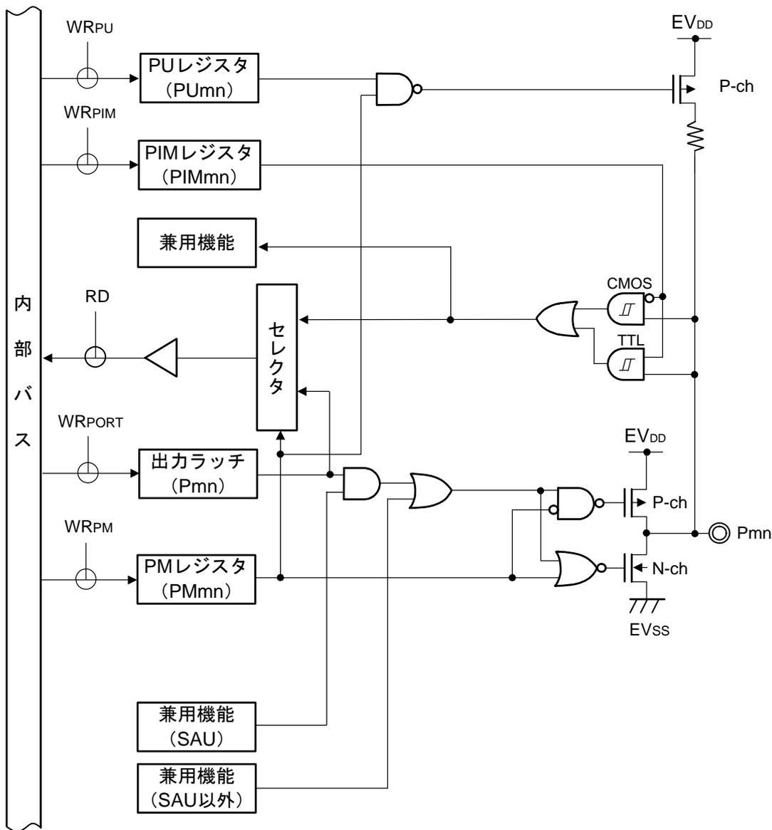
**注意** ポート入力モード・レジスタ(PIMx)でTTL入力バッファに設定し、ハイレベルを入力している場合、TTL入力バッファの構造により貫通電流が流れることがあります。貫通電流を防ぐためには、ローレベルを入力してください。
