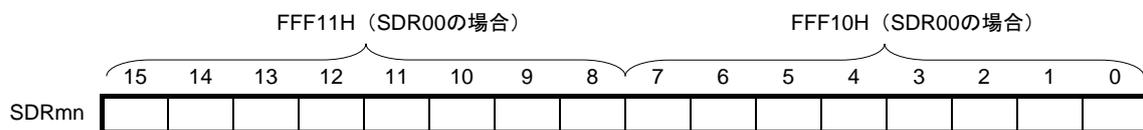
アドレス : FFF44H, FFF45H (SDR02) , FFF46H, FFF47H (SDR03)     リセット時 : 0000H     R/W
