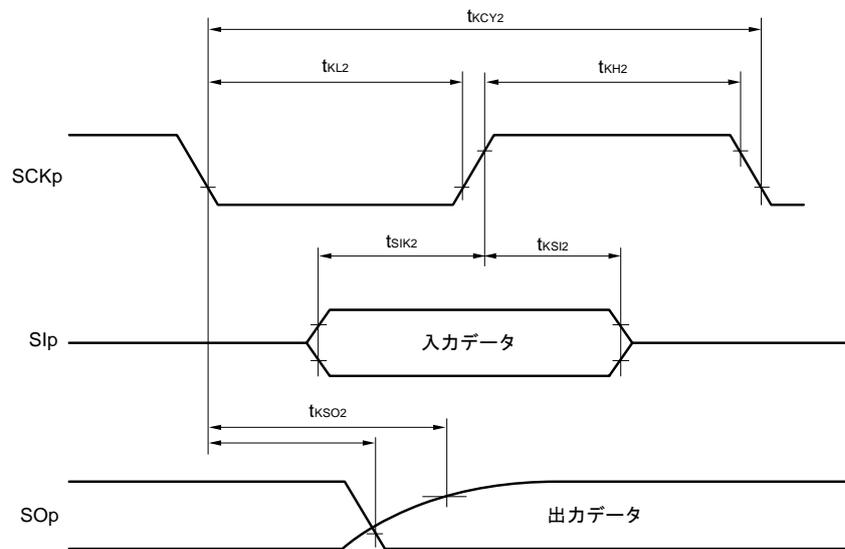
CSIモード・シリアル転送タイミング：スレーブ・モード（異電位通信時）
