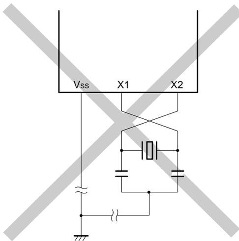
(d) X1, X2端子配線の下に電源/GNDパターンがある
