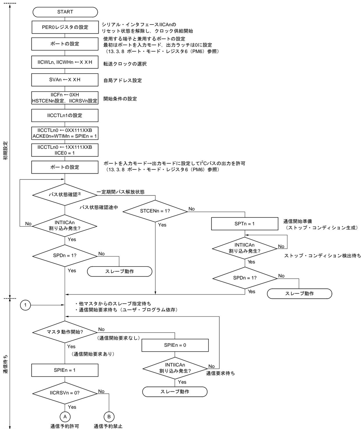
**注** 一定期間 (たとえば1フレーム分), バス解放状態 (CLDnビット = 1, DADnビット = 1) であることを確認してください。定常的にSDAAn端子がロウ・レベルの場合は, 通信している製品の仕様に準拠し, I<sup>2</sup>Cバスを解放 (SCLAn, SDAAn端子 = ハイ・レベル) するか判断してください。
