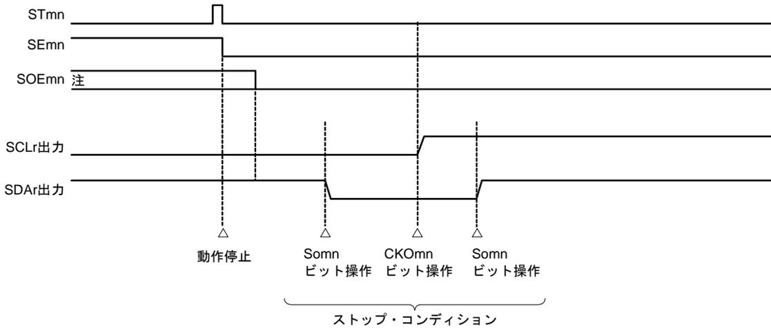
**注** 受信動作時は最終データを受信する前に、シリアル出力許可レジスタm (SOEm) のSOEmnビットを“0”に設定しています。
