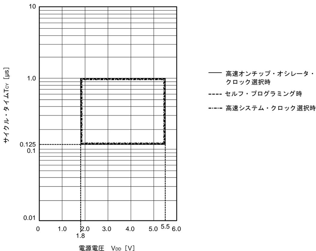
T<sub>CY</sub> vs V<sub>DD</sub> (LV (低電圧メイン) モード)
