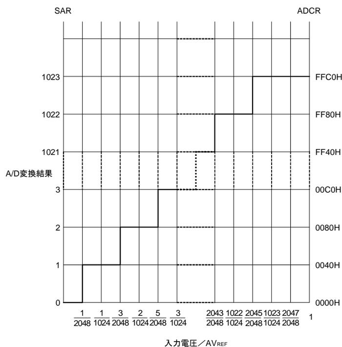
**備考**  $V_{\text{REF}}$  : A/Dコンバータの+側基準電圧。 $V_{\text{REFP}}$ , 内部基準電圧 (1.45 V) ,  $V_{\text{DD}}$ から選択可能です。
