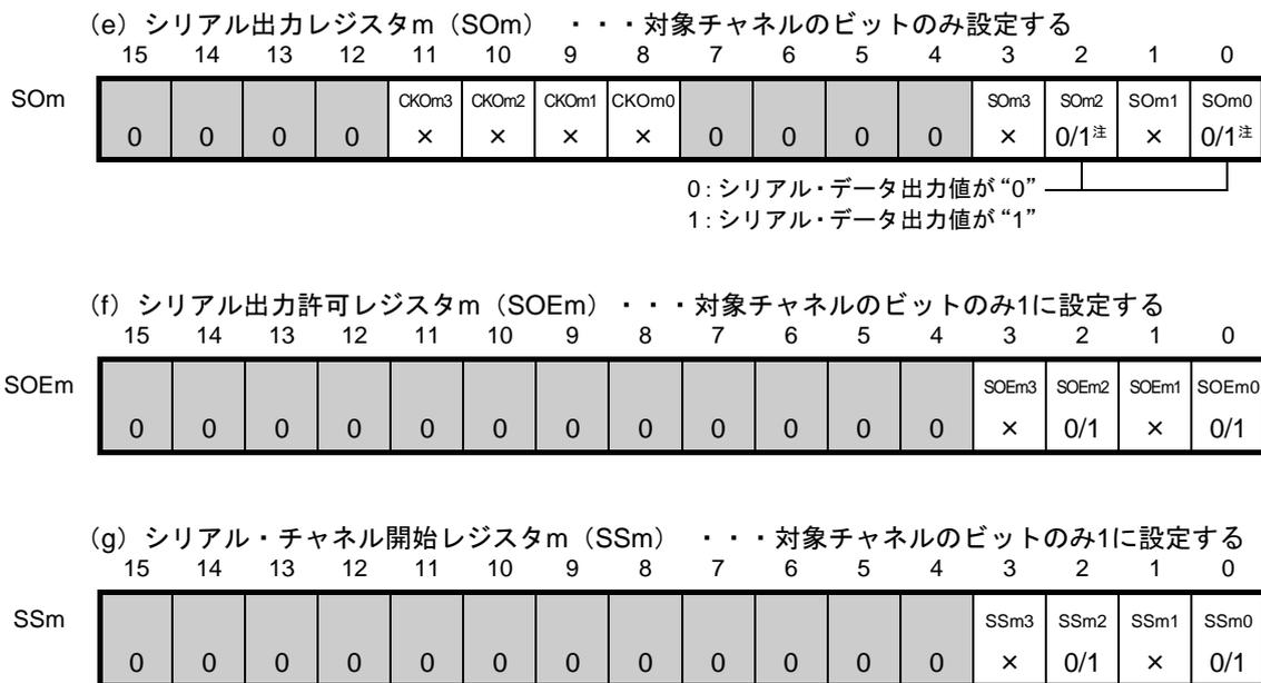
注 該当するチャネルのSOLmnビットに0を設定している場合は“1”に、SOLmnビットに1を設定している場合は“0”を送信開始前に必ず設定してください。通信動作中は通信データにより値が変わります。
