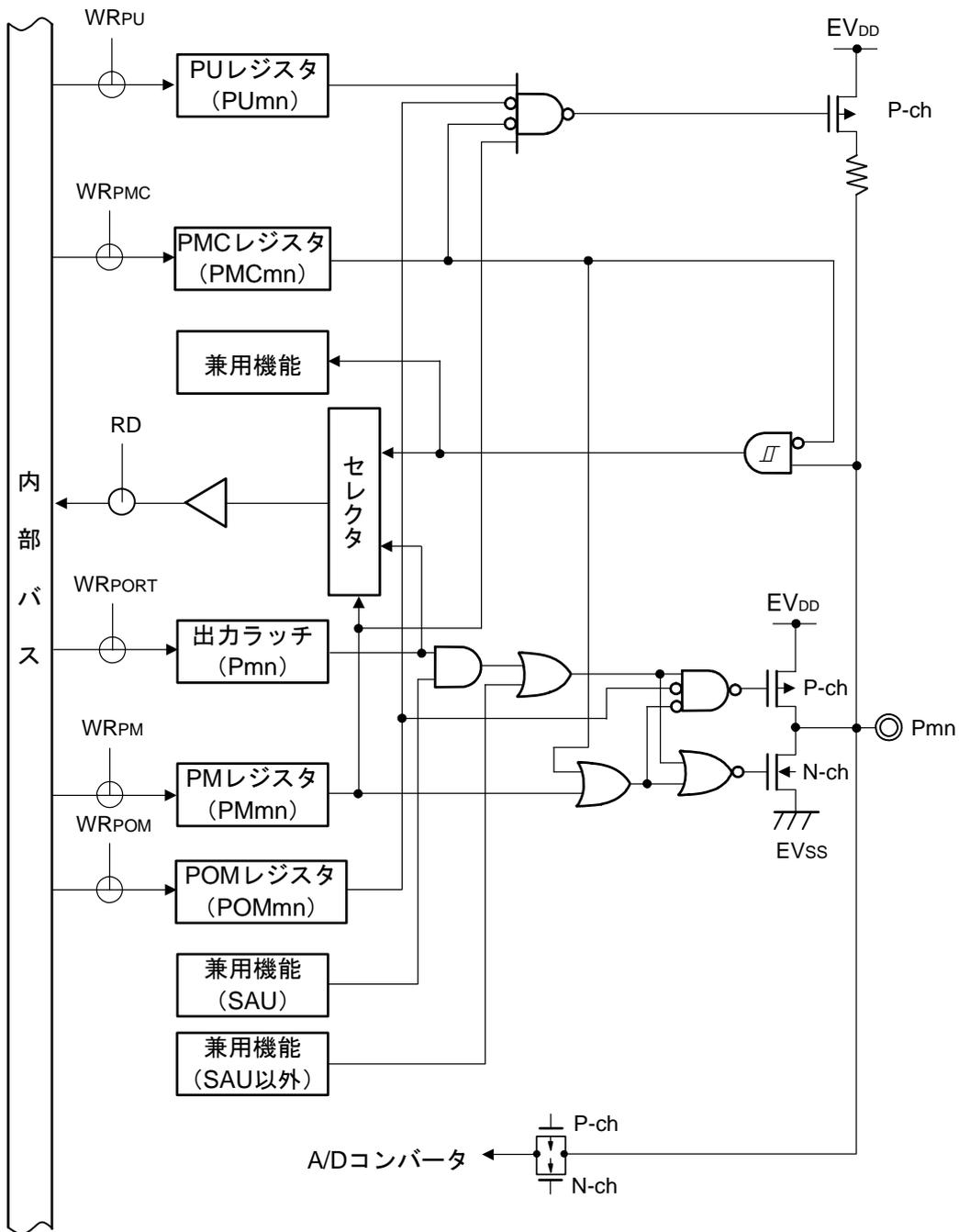
**注意** ポート出力モード・レジスタ(POMx)でN-chオープン・ドレイン出力モード設定時は、出力モード時においても、入力バッファがオンになっているため、中間電位となった場合、貫通電流が流れることがあります。また、N-chオープン・ドレイン出力モード設定時は、出力レベルを切り替えるとグリッチ(EV<sub>DD</sub>レベル)が発生することがあります。
