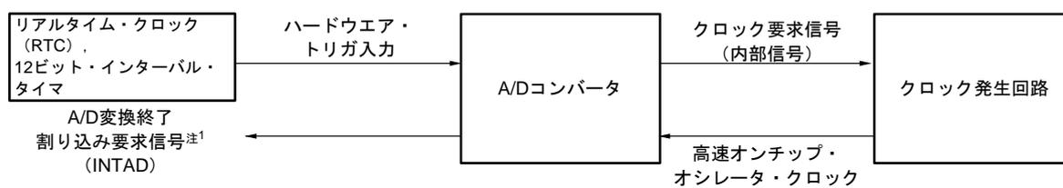
SNOOZEモード機能を使用する場合は、STOPモードに移行する前に各レジスタの初期設定を行います（11.7.3 **ハードウェア・トリガ・ウェイト・モード設定**を参照<sup>注2</sup>）。STOPモードへ移行する直前に、A/Dコンバータ・モード・レジスタ2 (ADM2) のビット2 (AWC) に1を設定します。初期設定完了後、A/Dコンバータ・モード・レジスタ0 (ADM0) のビット0 (ADCE) に1を設定します。
