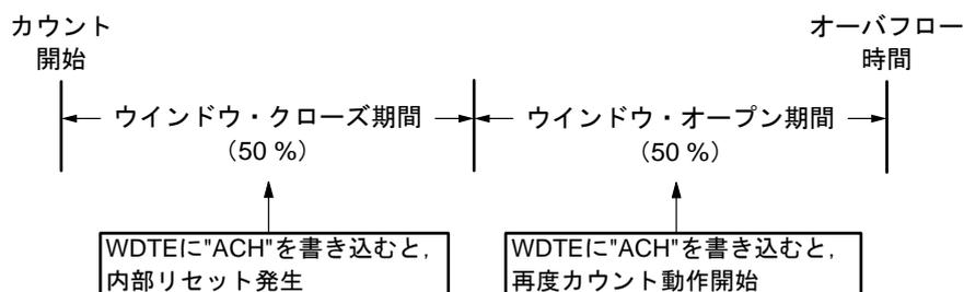
**注意** リセット解除後1回目のWDTEレジスタへの書き込みだけは、ウインドウ・オープン時間に関係なく、オーバフロー時間前であればどのタイミングで行ってもウォッチドッグ・タイマはクリアされ、再度カウント動作を開始します。
