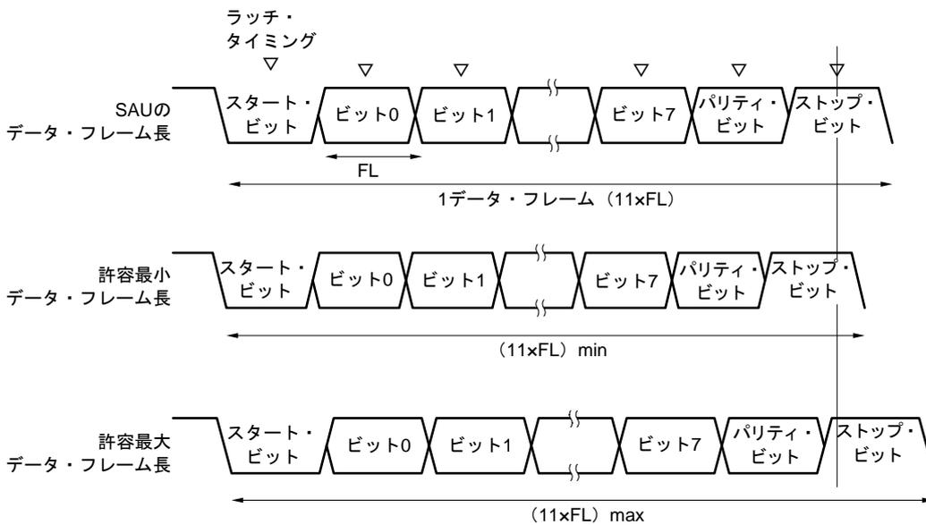
図12-95に示すように、スタート・ビット検出後はシリアル・データ・レジスタmn (SDRmn) のビット15-9で設定した分周比により、受信データのラッチ・タイミングが決定されます。このラッチ・タイミングに最終データ (ストップ・ビット) までが間に合えば正常に受信できます。
