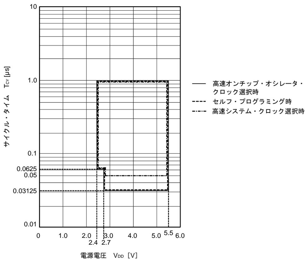
T<sub>CY</sub> vs V<sub>DD</sub> (LS (低速メイン) モード)
