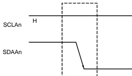
スタート・コンディションは，ストップ・コンディション検出状態 (SPDn: IICAステータス・レジスタn (IICSn) のビット0 = 1) のときにIICAコントロール・レジスタn0 (IICCTLn0) のビット1 (STTn) をセット (1) すると出力されます。また，スタート・コンディションを検出すると，IICSnレジスタのビット1 (STDn) がセット (1) されます。
