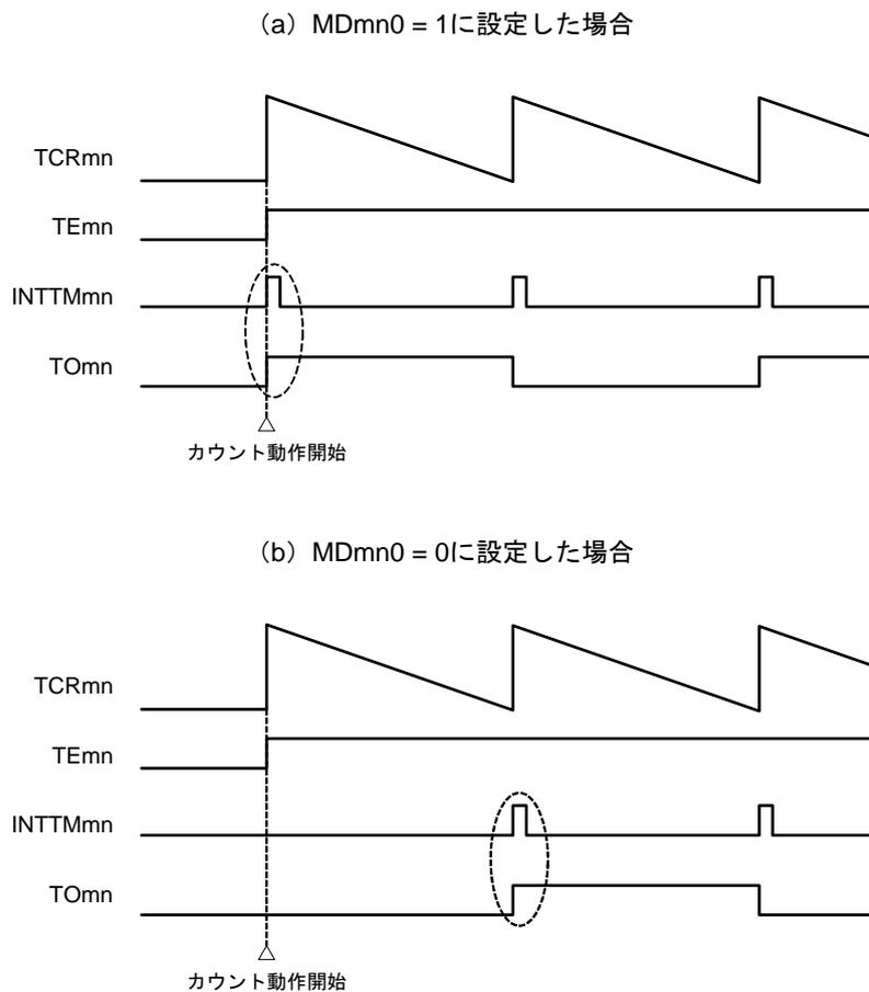
MDmn0 = 1に設定した場合、カウント動作開始時にタイマ割り込み (INTTMmn) が出力され、TOMnがトグル動作します。
