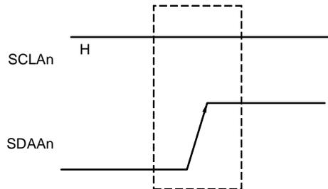
ストップ・コンディションは、IICAコントロール・レジスタn0 (IICCTLn0) のビット0 (SPTn) をセット (1) すると発生します。また、ストップ・コンディションを検出するとIICAステータス・レジスタn (IICSn) のビット0 (SPDn) がセット (1) され、IICCTLn0レジスタのビット4 (SPIEn) がセット (1) されている場合にはINTIICAnが発生します。
