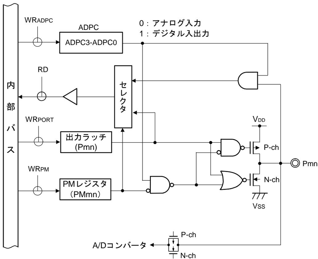
図2-6 端子タイプ 7-1-1 の端子ブロック図
