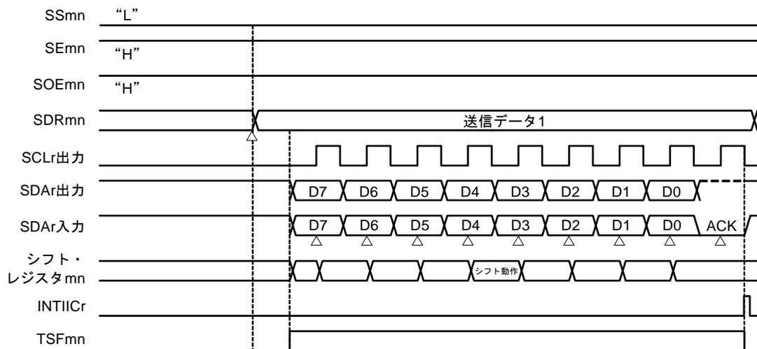
図12-109 簡易I<sup>2</sup>Cデータ送金のフロー・チャート
