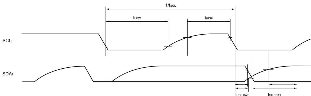
**注意** ポート入力モード・レジスタg (PIMg) とポート出力モード・レジスタg (POMg) で、SDArはTTL入力バッファ、N-chオープン・ドレイン出力 ( $V_{DD}$ 耐圧 (44, 48ピン製品の場合) /  $EV_{DD}$ 耐圧 (64, 100ピン製品の場合) モード) を選択し、SCLrはN-chオープン・ドレイン出力 ( $V_{DD}$ 耐圧 (44, 48ピン製品の場合) /  $EV_{DD}$ 耐圧 (64, 100ピン製品の場合) モード) を選択します。なお $V_{IH}$ 、 $V_{IL}$ は、TTL入力バッファ選択時のDC特性を参照してください。
