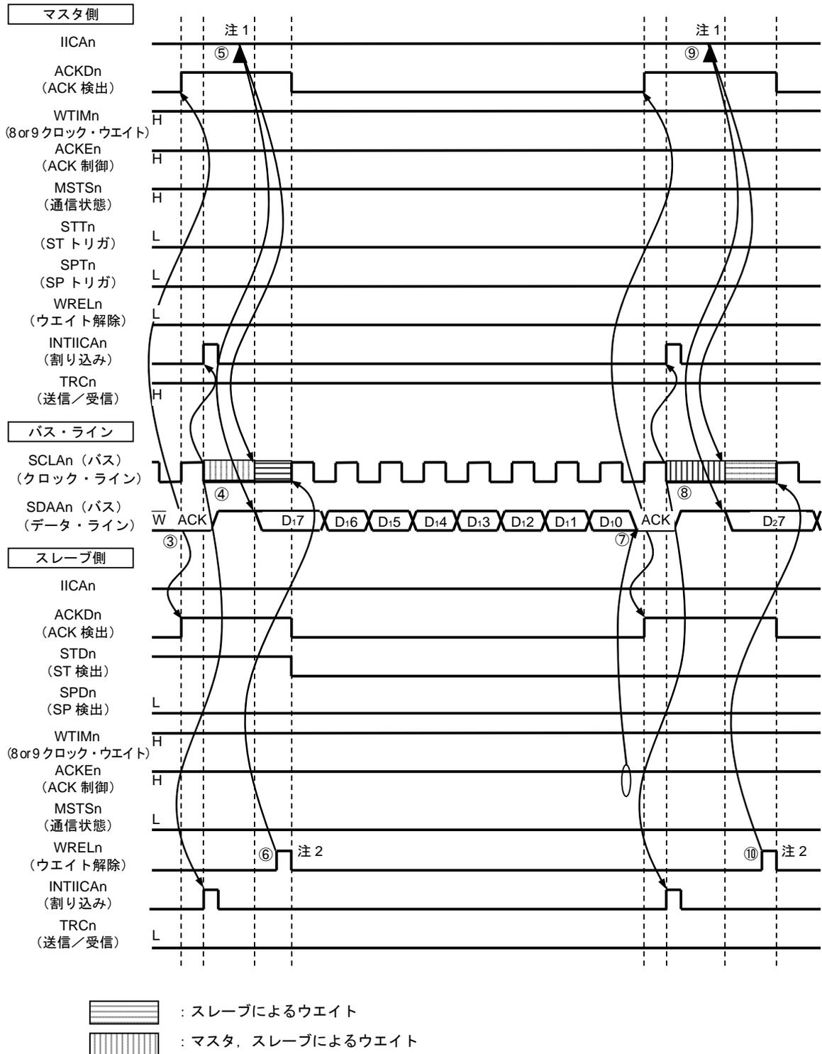
注1. マスタ側での送信時のウェイト解除は、WRELnビットのセットではなく、IICAnへのデータ書き込みで行ってください。
