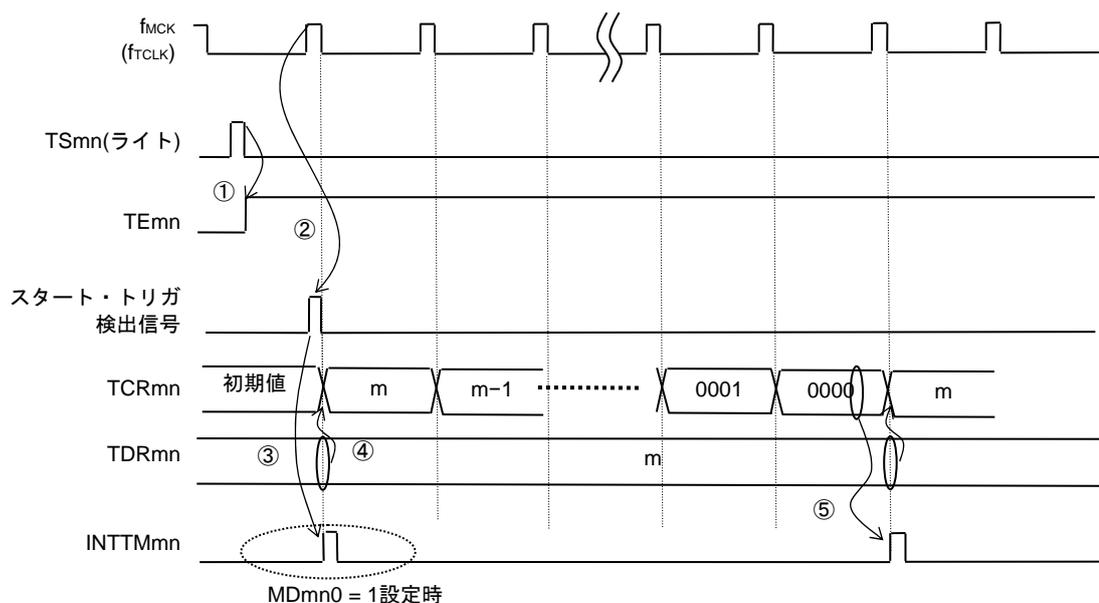
**注意** カウント・クロックの1周期目の動作はTSmnビット書き込み後、カウント・クロックが発生するまでカウント開始が遅れるため、1周期目は最大でカウント・クロック1クロック分の誤差が生じます。また、カウント開始タイミングの情報が必要な場合は、MDmn0 = 1に設定することで、カウント開始時に割り込みを発生させることができます。
