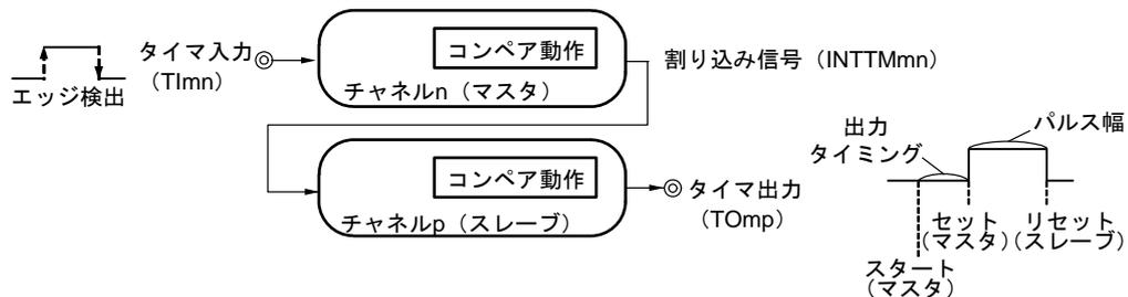
(2) PWM (Pulse Width Modulation) 出力
