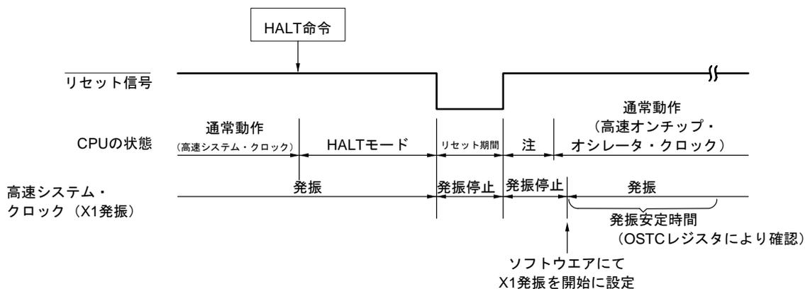
**注** リセット処理時間は、**第19章 リセット機能**を参照してください。なお、パワーオン・リセット (POR) 回路と電圧検出 (LVD) 回路のリセット処理時間は、**第20章 パワーオン・リセット回路**を参照してください。
