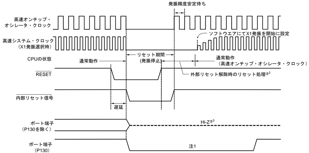
ウォッチドッグ・タイマのオーバーフロー／不正命令の実行／RAMパリティ・エラーの検出／不正メモリ・アクセスの検出によるリセットは、自動的にリセットが解除され、リセット処理後、高速オンチップ・オシレータ・クロックでプログラムの実行を開始します。
