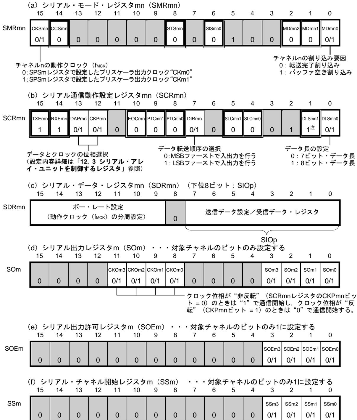
注 SCR00, SCR01レジスタと、100ピン製品のSCR10, SCR11レジスタのみ。その他は1固定になります。
