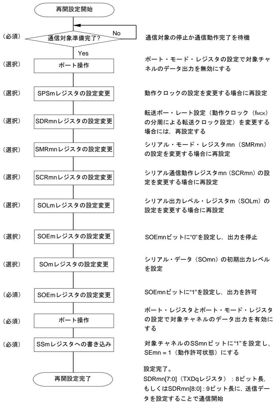
**備考** 中断設定でPER0を書き換えてクロック供給を停止した場合には、通信対象の停止か通信動作完了を待って、再開設定ではなく初期設定をしてください。
