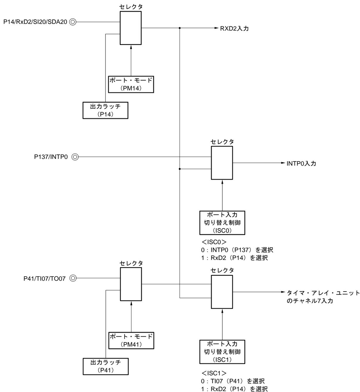
**備考** ISC0, ISC1 : 入力切り替え制御レジスタ (ISC) のビット0, 1 (図12-21参照)
