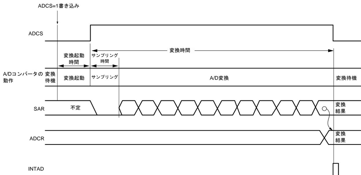
ワンショット変換モード時のA/D変換動作は、A/D変換終了後にADCSビットが自動的にクリア(0)されます。
