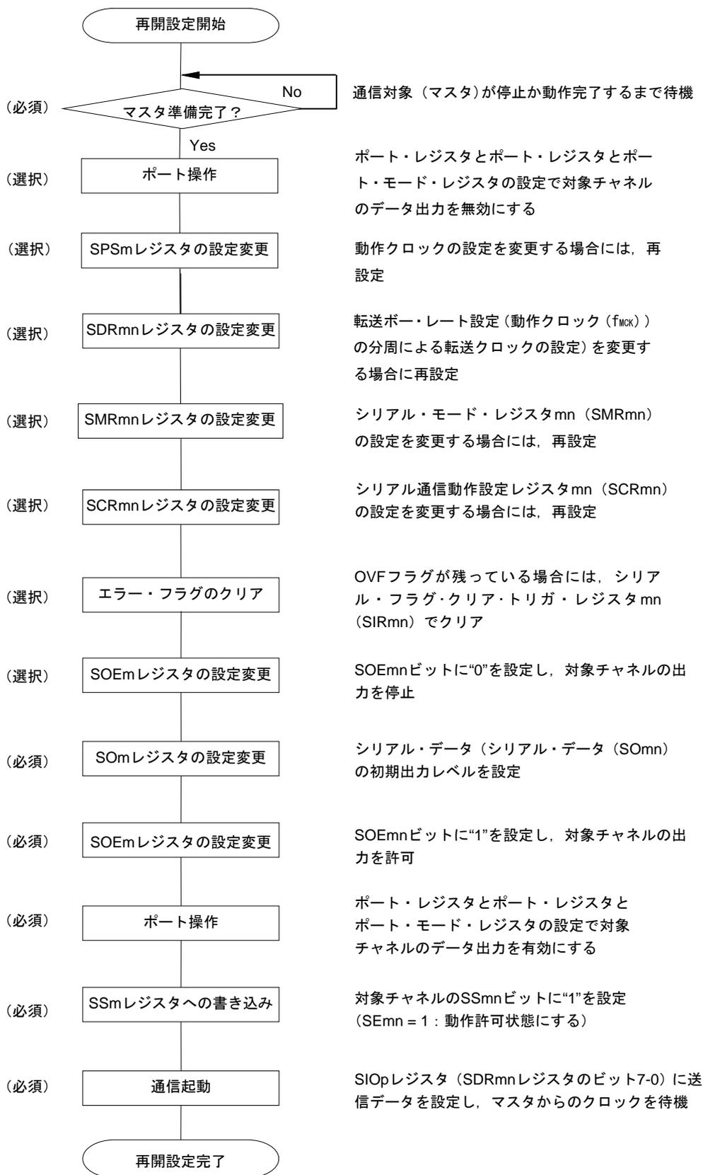
**備考** 中断設定でPER0を書き換えてクロック供給を停止した場合には、通信対象（マスタ）の停止か通信動作完了を待って、再開設定ではなく初期設定をしてください。
