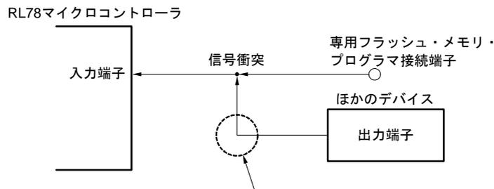
フラッシュ・メモリ・プログラミング・モードでは、ほかのデバイスが出力する信号と専用フラッシュ・メモリ・プログラマから送り出される信号が衝突するため、ほかのデバイス側の信号をアイソレートしてください。
