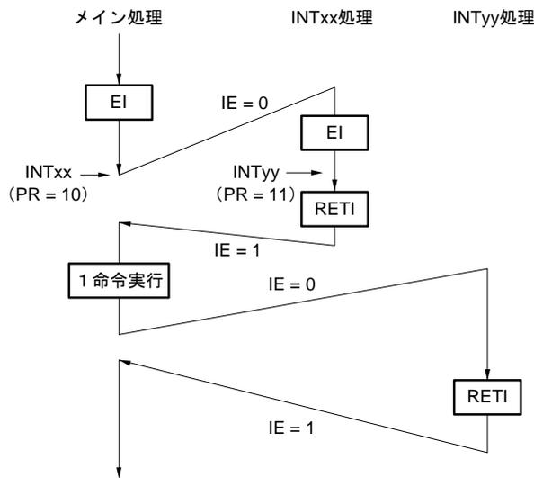
割り込みINTxx処理中に発生した割り込み要求INTyyは、割り込みの優先順位がINTxxより低いため受け付けられず、多重割り込みは発生しない。INTyy要求は保留され、メイン処理1命令実行後に受け付けられる。
