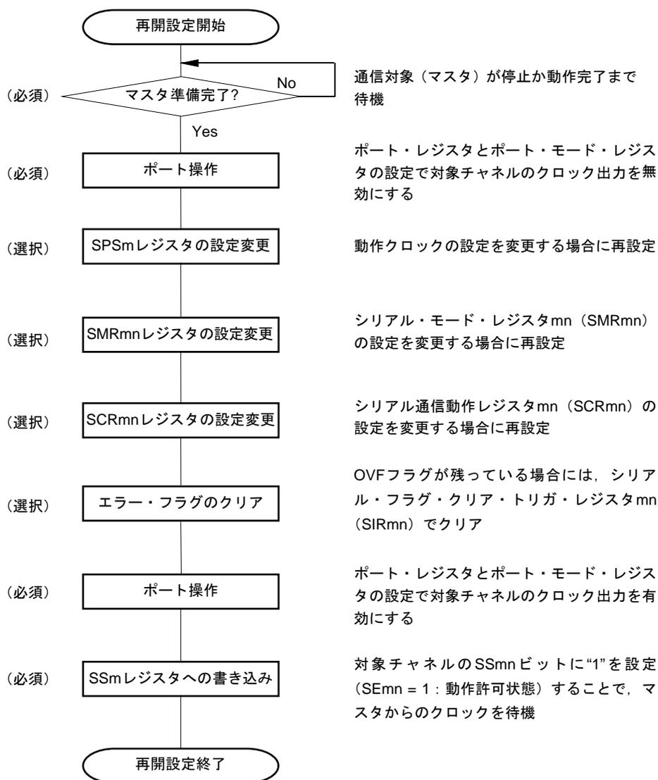
**備考** 中断設定でPER0を書き換えてクロック供給を停止した場合には、通信対象(マスター)の停止か通信動作完了を待って、再開設定ではなく初期設定をしてください。
