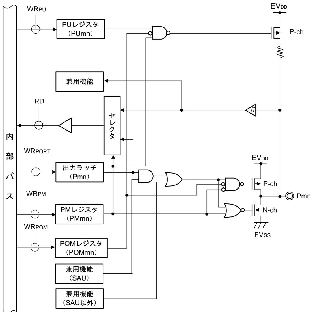
**注意** ポート出力モード・レジスタ(POMx)でN-chオープン・ドレイン出力モード設定時は、出力モード時においても、入力バッファがオンになっているため、中間電位となった場合、貫通電流が流れることがあります。また、N-chオープン・ドレイン出力モード設定時は、出力レベルを切り替えるとグリッチ(EV<sub>DD</sub>レベル)が発生することがあります。
