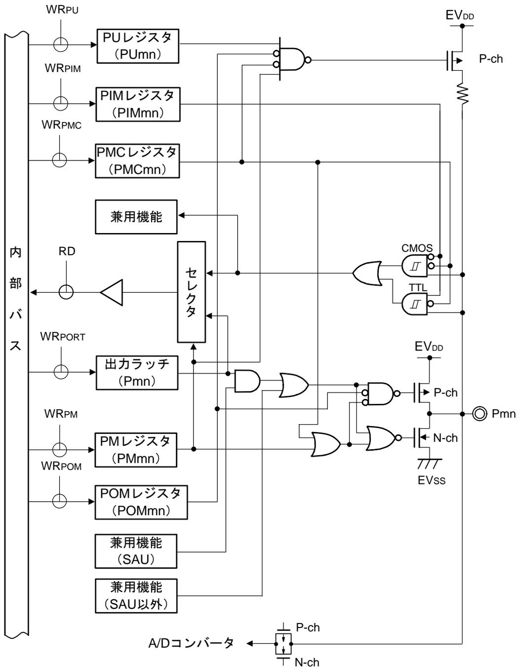
注意1. ポート出力モード・レジスタ(POMx)でN-chオープン・ドレイン出力モード設定時は、出力モード時においても、入力バッファがオンになっているため、中間電位となった場合、貫通電流が流れることがあります。また、N-chオープン・ドレイン出力モード設定時は、出力レベルを切り替えるとグリッチ(EV<sub>DD</sub>レベル)が発生することがあります。
