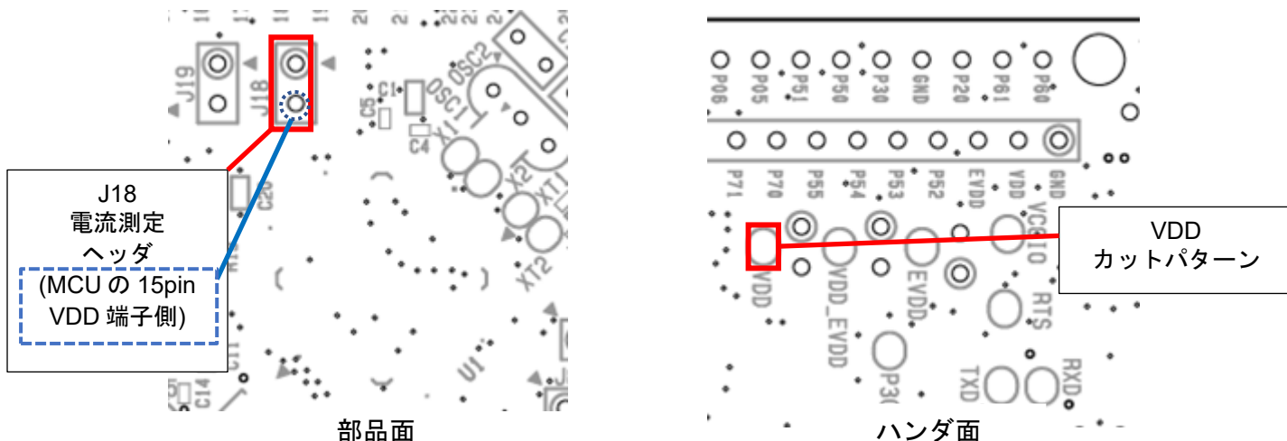
図 5-8 : J18 電流測定ヘッダ および VDD カットパターン位置
