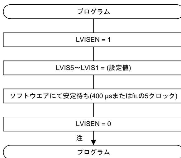
注 LVISEN = 0 設定後、 $V_{LVD} > V_{DD}$  ならばLVD検出し、リセット/割り込みが発生します。
