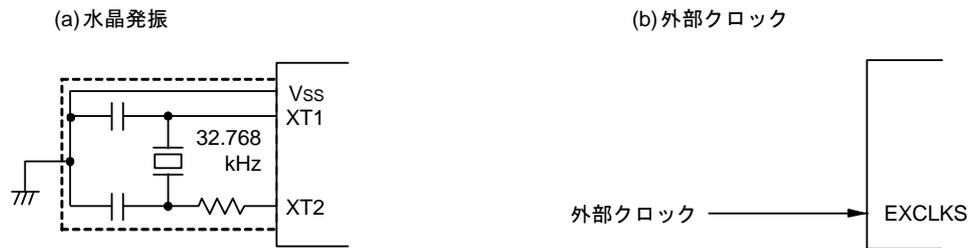
注意 XT1発振回路およびXT1発振回路を使用する場合は、配線容量などの影響を避けるために、図6-16、図6-17の破線の部分を次のように配線してください。
