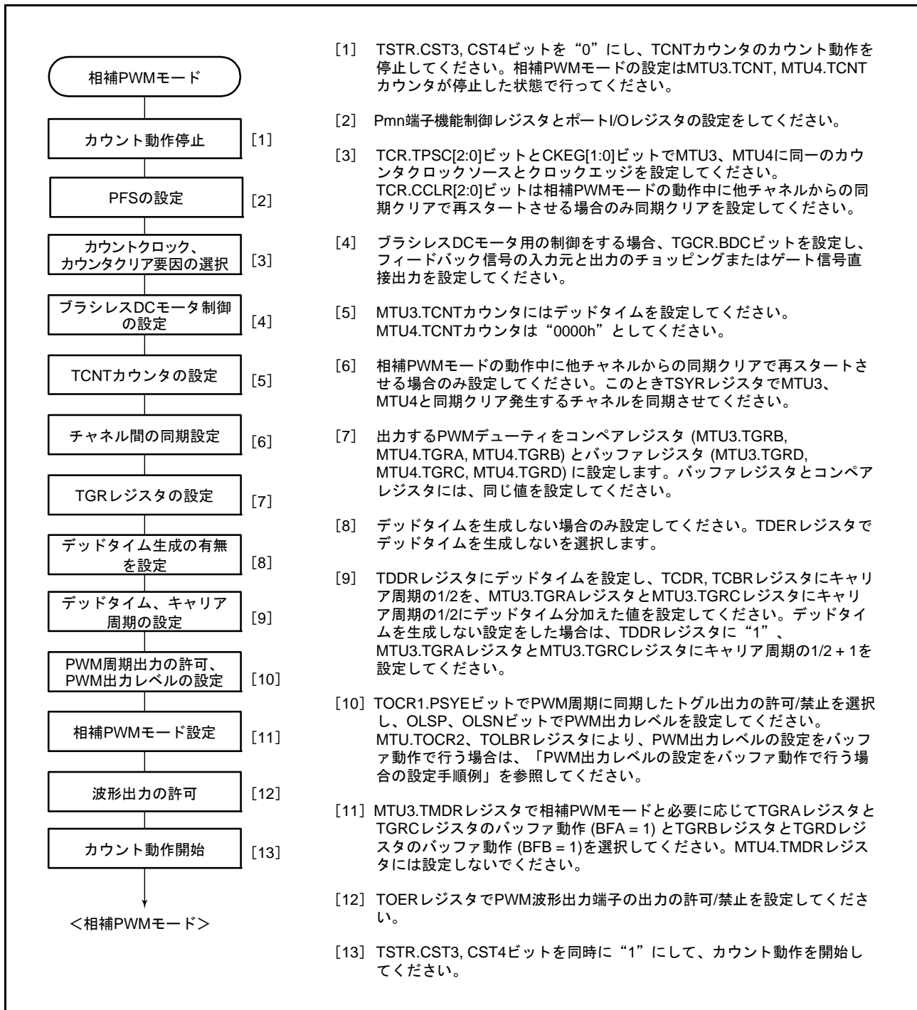
図 20.38 相補 PWM モードの設定手順例
