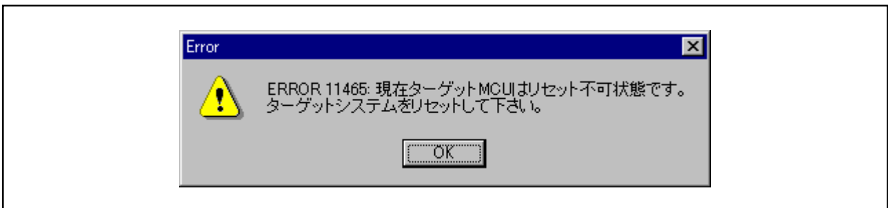
図 6.12 起動時のエラーダイアログ(M3A-2152 評価ボード側異常)
