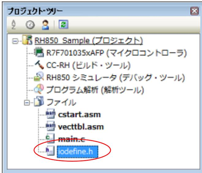
**備考** I/O ヘッダ・ファイルはプロジェクト・ファイルと同じフォルダに生成されます。すでに同名ファイルが存在していた場合、既存のファイルを“iodefine.bak”にリネームしてバックアップします。
