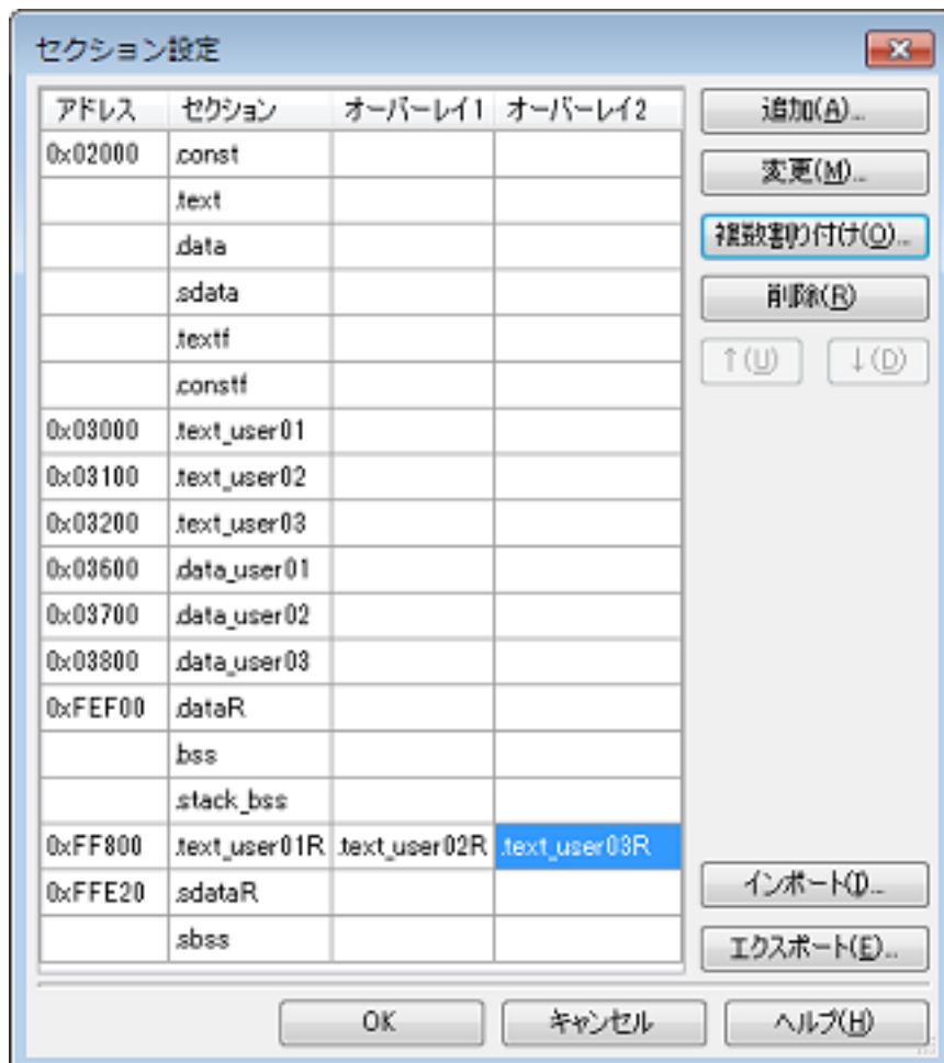
図 2.48 セクション設定 ダイアログ (オーバーレイ・セクション追加後)
