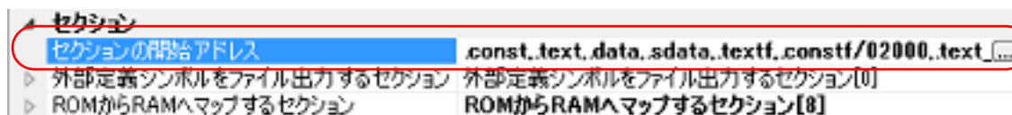
図 2.50 [セクションの開始アドレス] プロパティ (セクション設定後)
