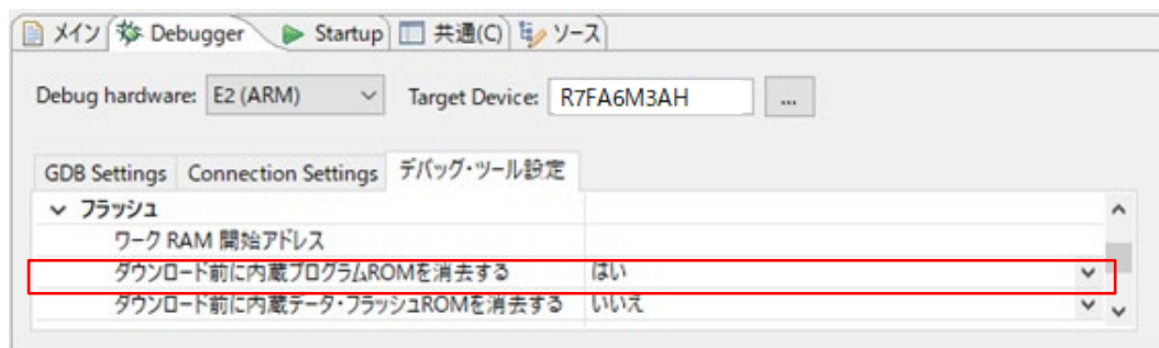
図3-9 [ダウンロード前に内蔵プログラムROMを消去する]の設定
