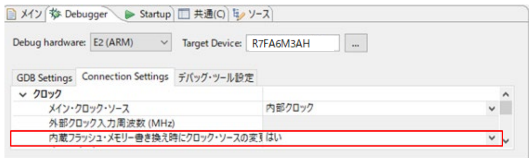
図3-11 [内蔵フラッシュ・メモリー書き換え時にクロック・ソースの変更] の設定
