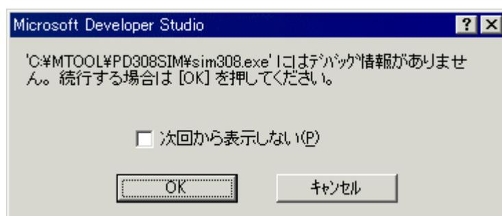
5. シミュレータエンジン sim308.exe の起動後、PD308SIM を起動すると I/O DLL をデバッグできます (sim308.exe は、起動後 Windows のシステムトレイに登録 (表示) されますので、それを確認後に PD308SIM を起動してください)。
