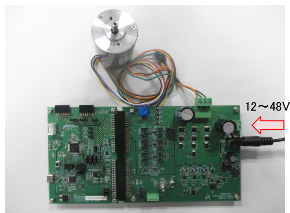
図 4-10 DC ジャックから電源供給
