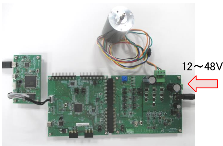
図 4-10 DC ジャックから電源供給
