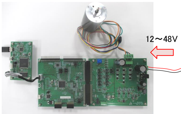
図 4-11 端子台から電源供給
