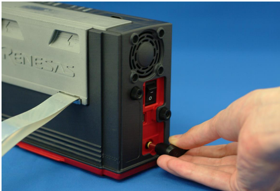
図2.5 エミュレータ用電源の接続
