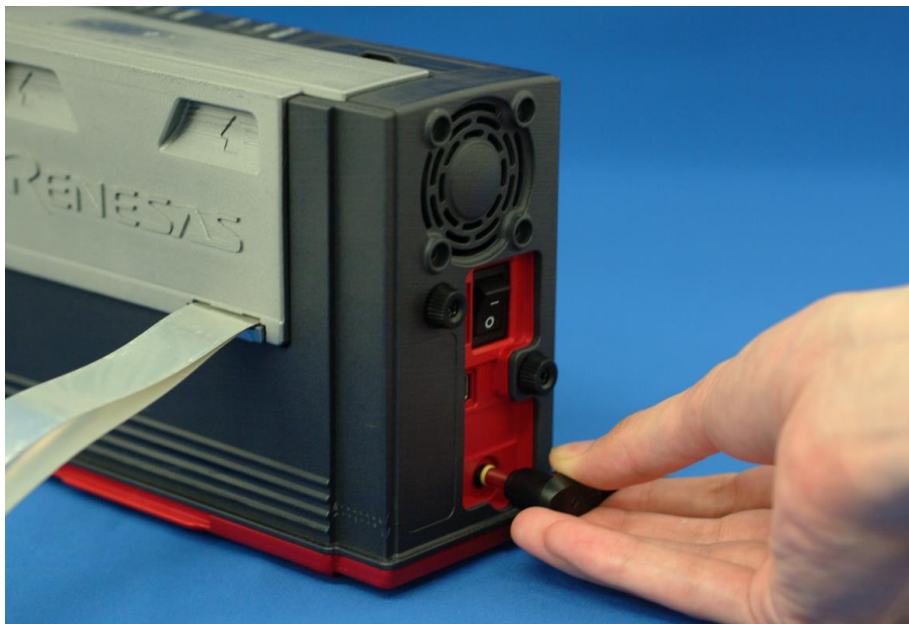
図2.5 エミュレータ用電源の接続
