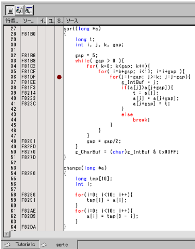
図3.43 [エディタ]ウィンドウ (ソフトウェアブレークポイントの設定)
