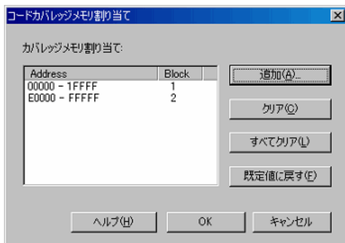
図5.72 [コードカバレッジメモリ割り当て] ダイアログボックス
