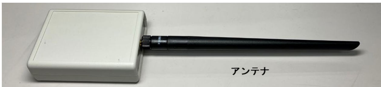
図 3-2 : アンテナ取り付け図
