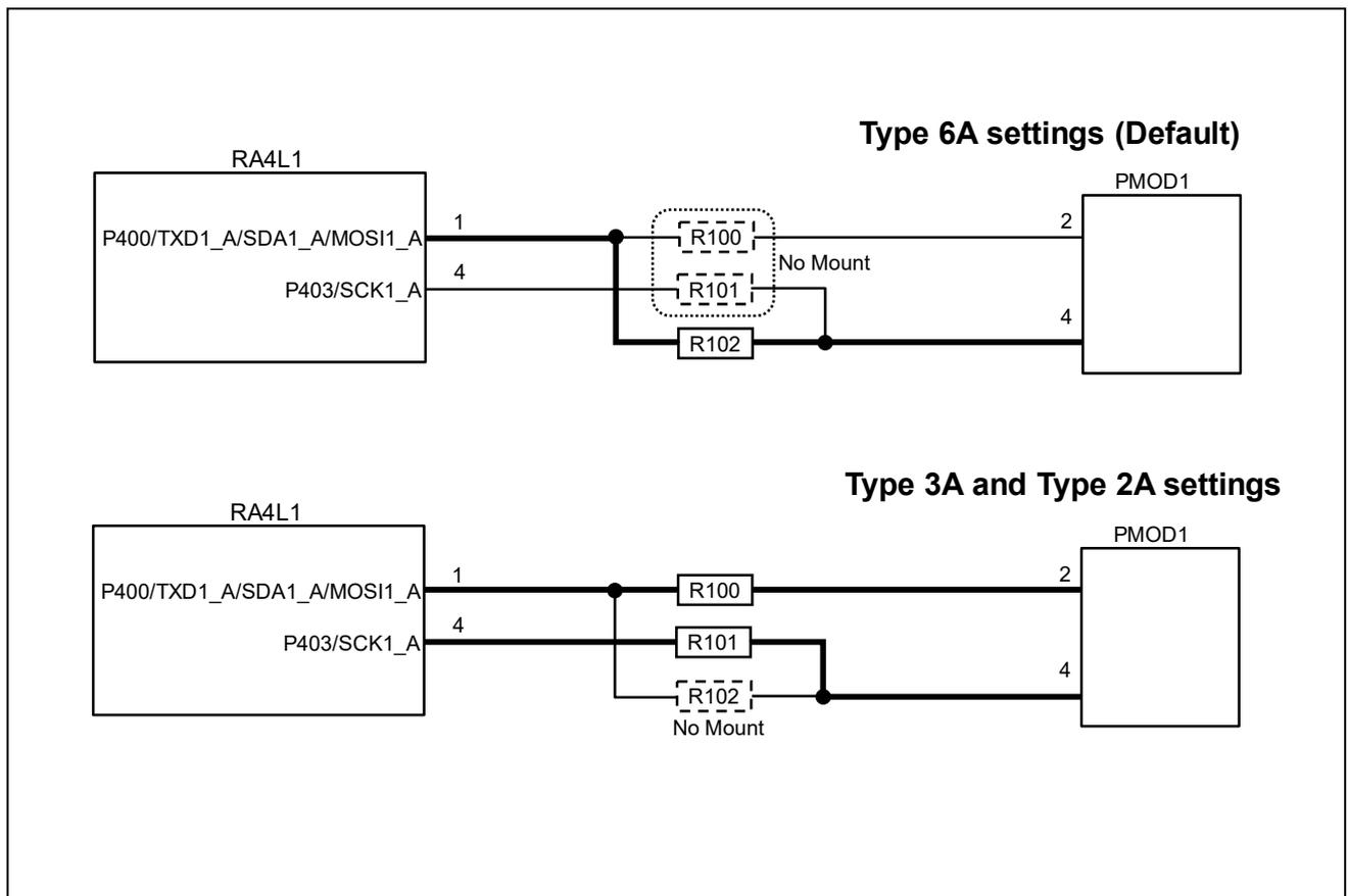
図 10 PMOD1インターフェース切替え回路
