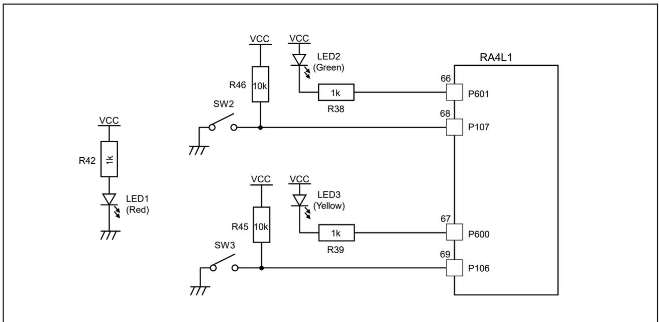
図 9 プッシュスイッチとLED回路
