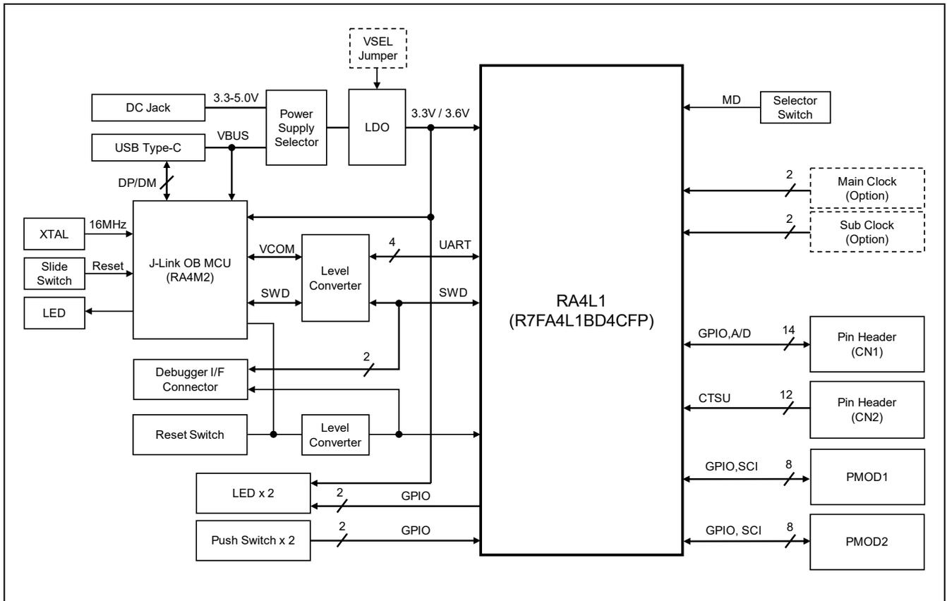
図 5 CPUボード ブロック図
