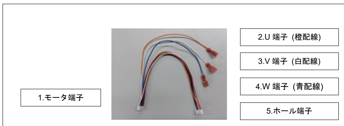
Figure 2-5 モータ接続ケーブル接続先
