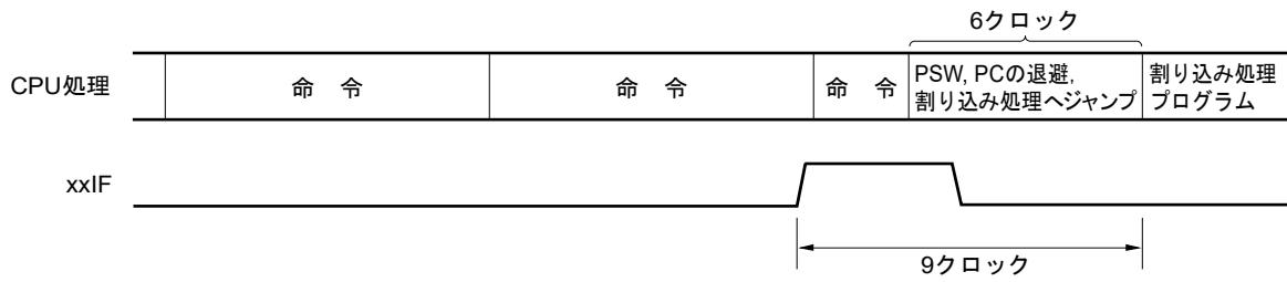
図19-8 割り込み要求の受け付けタイミング（最小時間）
