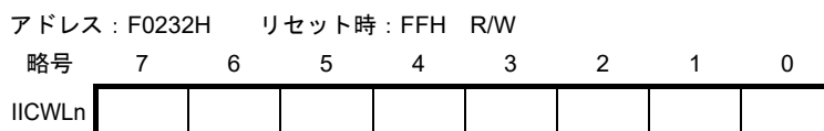
図15-10 IICAロウ・レベル幅設定レジスタn (IICWLn) のフォーマット
