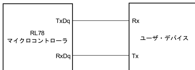
UARTモード接続図 (同電位通信時)
