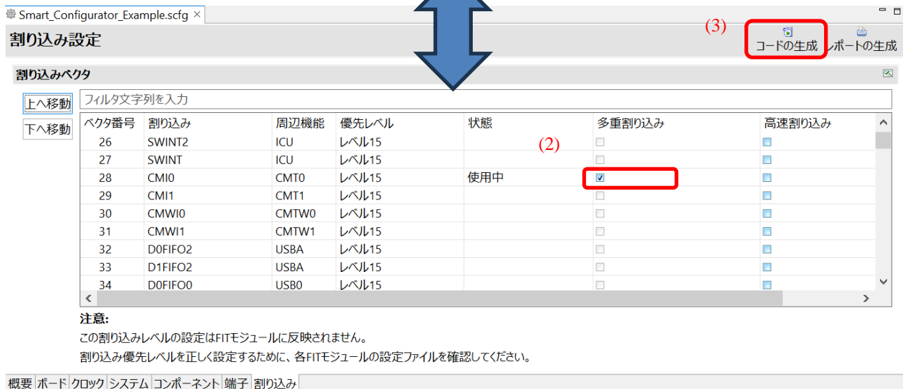
図 4-69 割り込みページの多重割り込み設定
