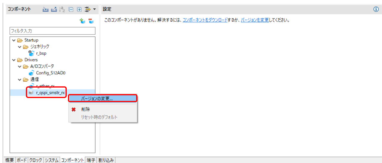
図 4-33 グレーアウト・コンポーネントのバージョン変更
