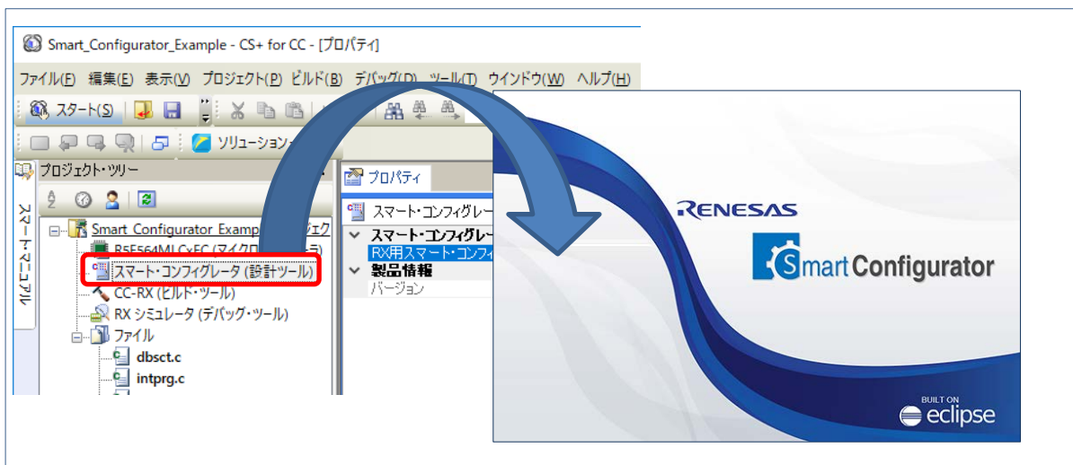
図 3-2 スマート・コンフィグレータの起動
