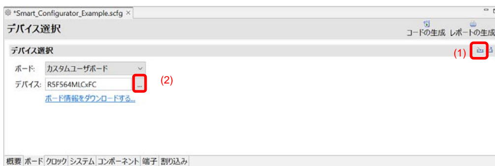
図 4-4 ボード設定のインポート(bdf 形式)
