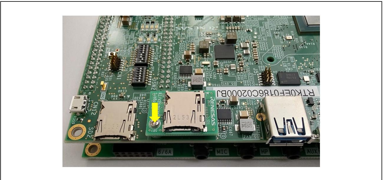
図 2.1-4 ネジを締めて Sub Board を固定（写真は microSD Sub Board 取付時）
