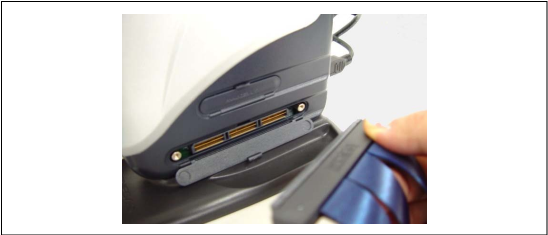
図 2.10 E200F 側のトレースケーブル接続方法
