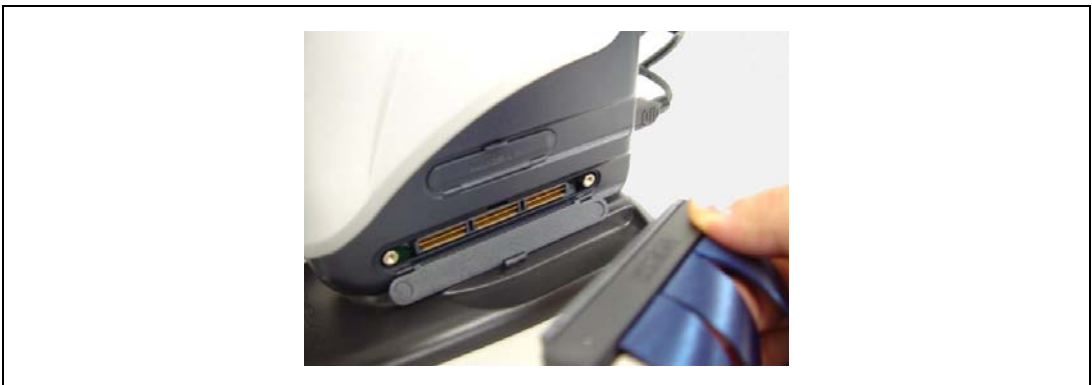
図 2.7 E200F 側のトレースケーブル接続方法
