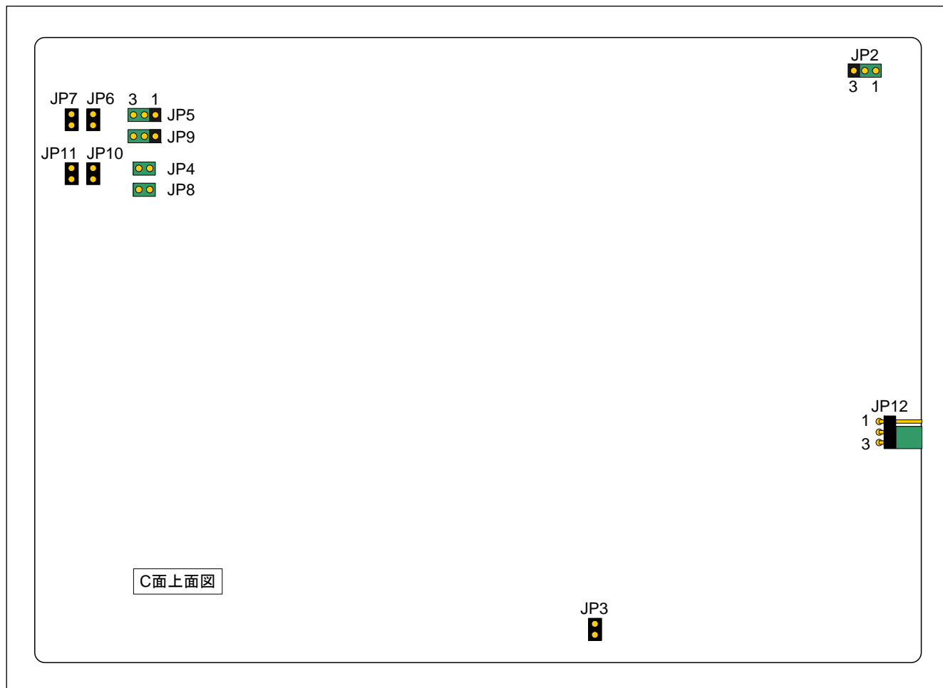
図6.2.2 M3A-HS64G01ジャンパ配置図 (JP2~JP12)
