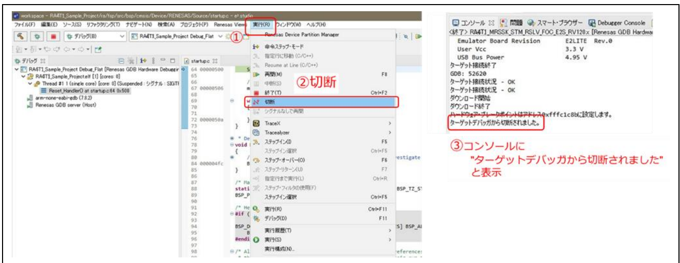
図 5-6 CPU ボードの取り外し
