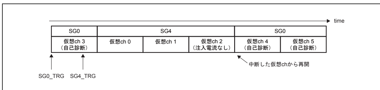
図 26.23 A/D 変換回路自己診断よりも高優先となる SG がある場合の設定例
