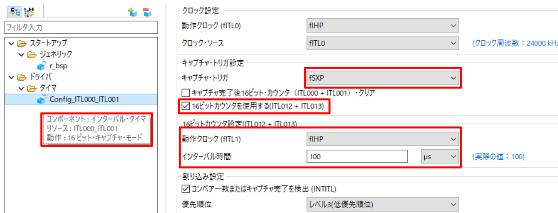
図 3-2 16 ビット・キャプチャ・モードでチャンネル 2 および 3 を 16 ビット・カウント・モードで使用
