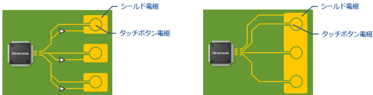
図 4: タッチパッド電極のシールドディングにおける二つのアプローチ
