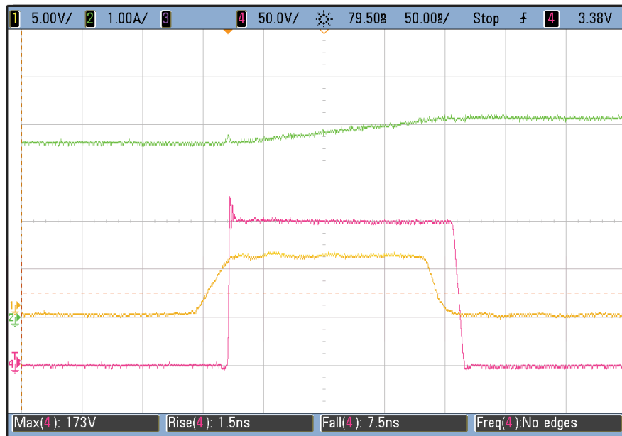
図3 - 150VIN から 5VOUT @ 4A (200kHz) でのバックコンバータの波形
