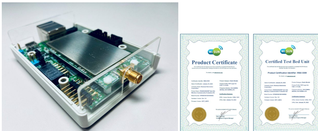
図 3 : Wi-SUN FAN 1.1 準拠 評価キット
