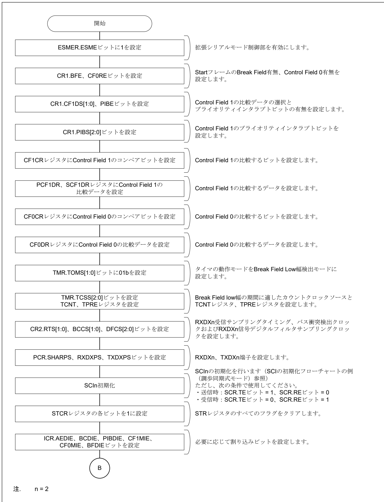
図 29.107 Start Frame 受信フローチャート例 (1)
