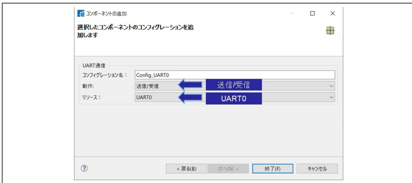
図 7-15 UART チャンネルの選択
